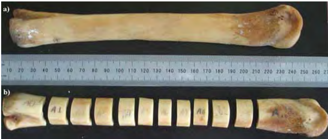
Figura 2. Foto mostrando: a) Osso após Processo 1: Limpeza; b) Osso após Processo 2: Confecção, com divisão da amostra em 12 partes.
