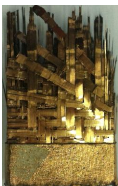
Figura 3.9 Cdp fraturado pré-preparado para análise no MEV.
