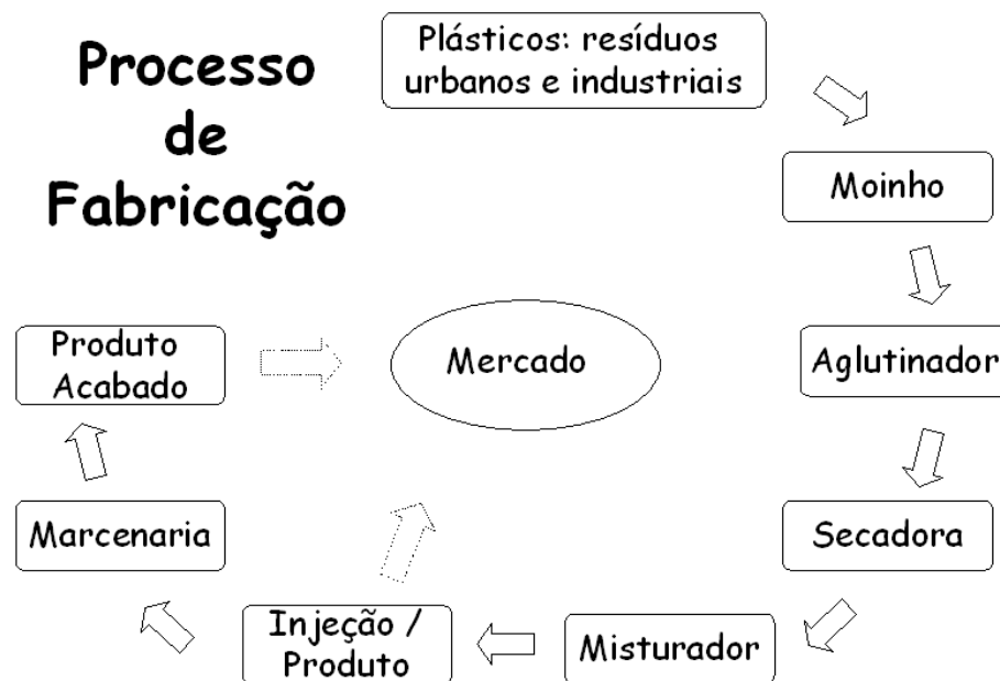
Figura 13 - Fluxograma do sistema de produção da madeira-plástica.
