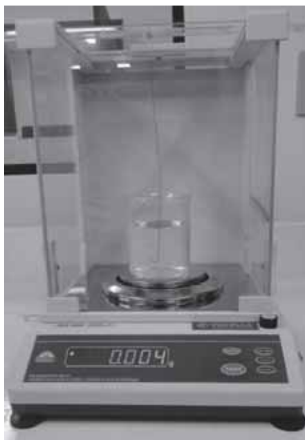
Figura 2: Foto do aparato para a determinação da densidade pelo método de imersão.
