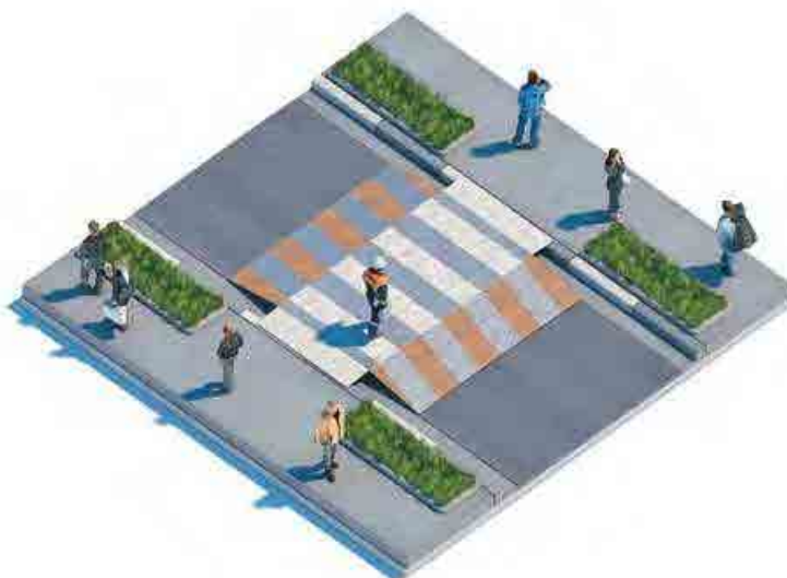
Figura 18 - Faixa de pedestres elevada - Fonte: Carvalho, 2011
