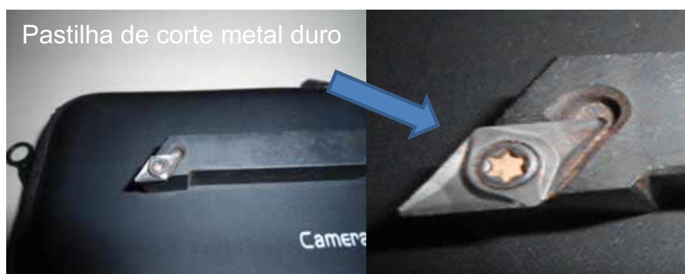
Figura 10: Pastilhas de metal duro
