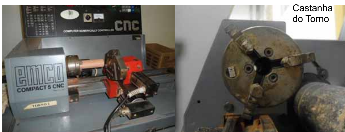
Figura 9: Peça presa ao torno e castanha do torno
