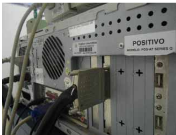
Figura 14: Cabo de comunicação modelo SHC68-EPM (2m) conectado a placa coletora de dados modelo NI PCI 6220
