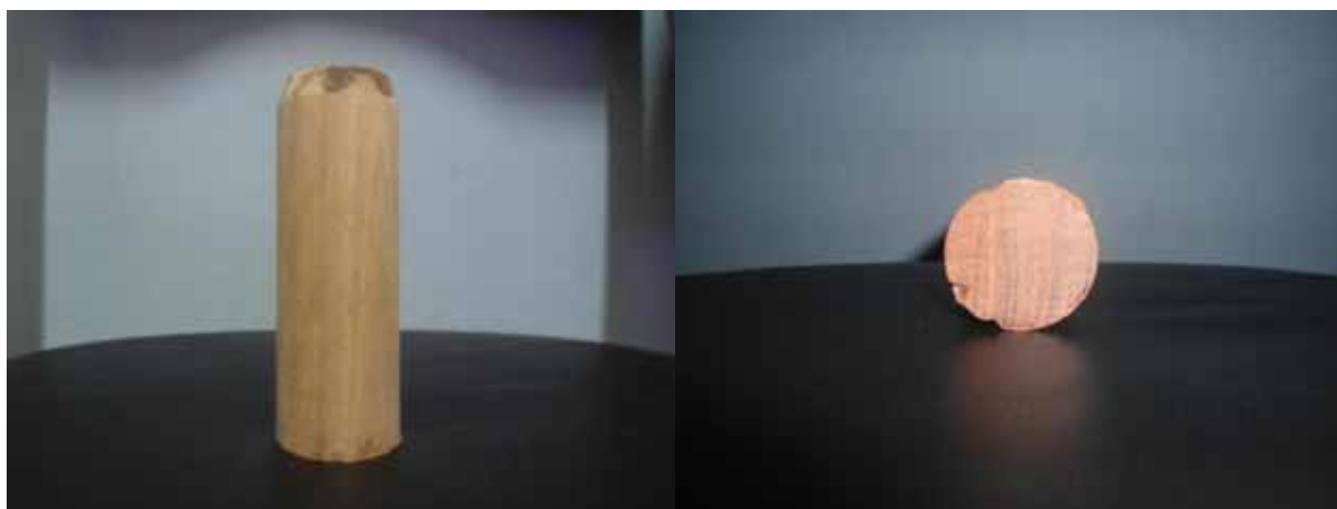
Figura 7: Corpo de prova de Corymbia citriodora
