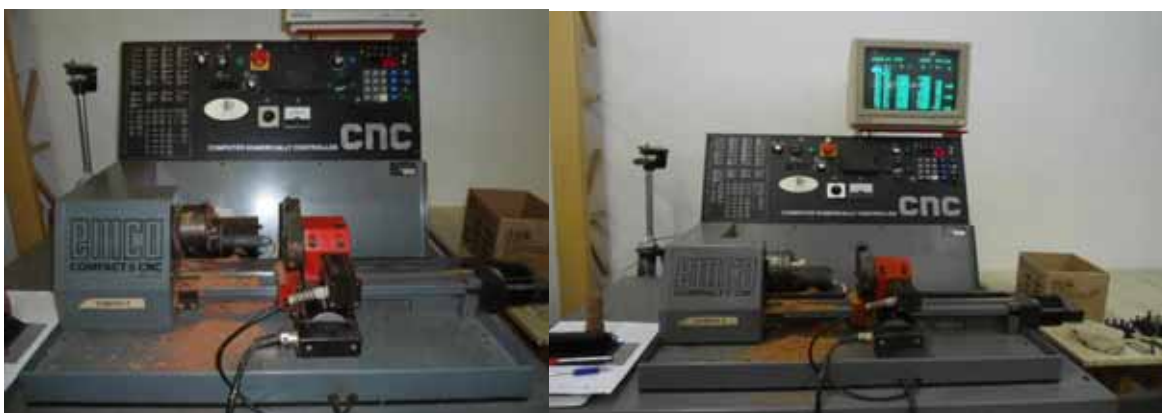
Figura 8: Torno CNC EMCO Compact 5
