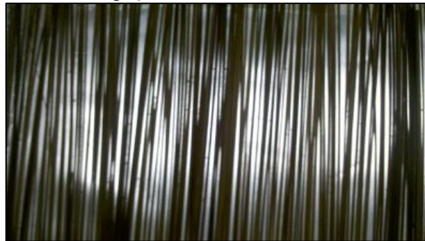
Figura 24 – Fotografia do compósito epóxi/fibras longas e unidirecionais de capim-sapê onde se observa macroscopicamente o espaçamento entre as fibras
