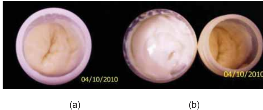
Figura 23 - (a) Amostra contendo 0,250% de TTO que sofreu mudança nas características organolépticas; (b) comparação da amostra citada em (a) com a amostra contendo 0,250% de TTO submetida à temperatura ambiente.
