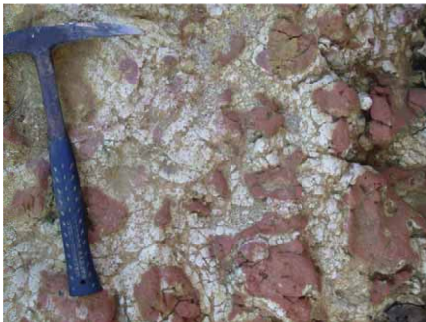
Figura 11 : Foto mostrando sedimentos fortemente plintitizados, composto por matriz argilosa caulínica com concreções ferruginosas arredondadas e irregulares.
