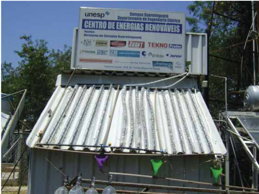
Figura 7 - Conjuntos de aquecedores
