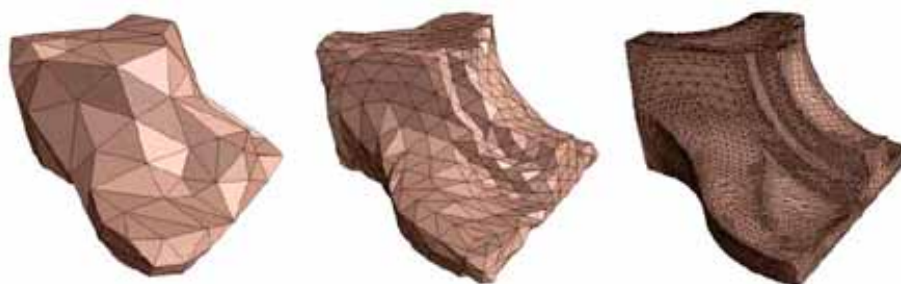
Figura 4.10: Modelo reconstruído utilizando-se wavelets com diferentes coeficientes de erro. Da esquerda para a direita, \epsilon = 9,0 , \epsilon = 2,75 e \epsilon = 0,1 (FLORIANI et al., 1999).
