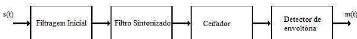
Figura 22: Processo de demodulação FM (O autor)
