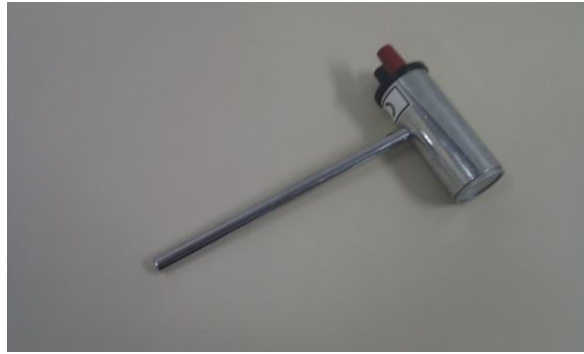
Figura 4: Termopile de Moll
