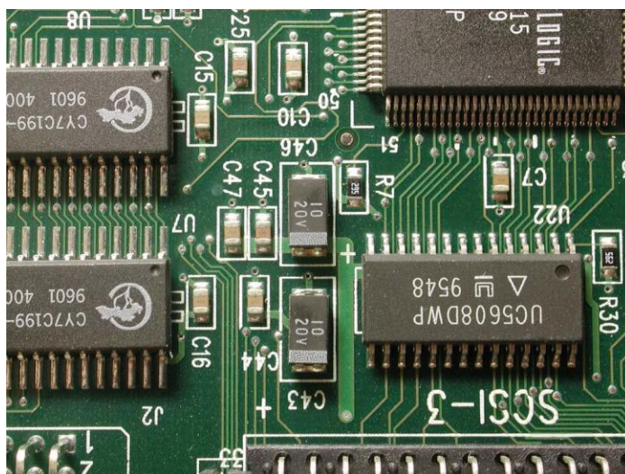
Figura 9: Close-up de placa de circuito apenas com componentes SMD
