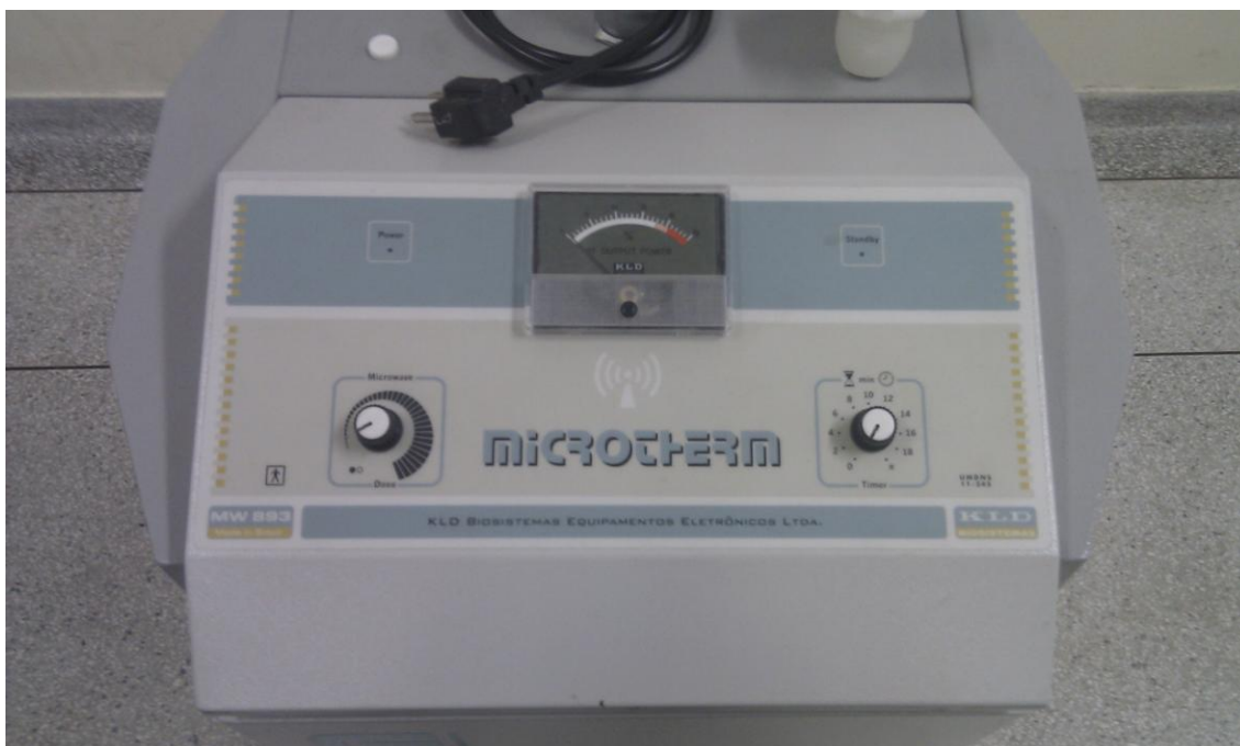
Figura 7: Potenciômetro e mostrador analógicos do aparelho de diatermia por microondas.
