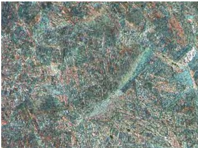
Figura 34: Corte Superficial – ZTA.
