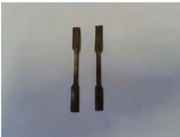
Figura 2: Corpos-de-prova para ensaio de tração
