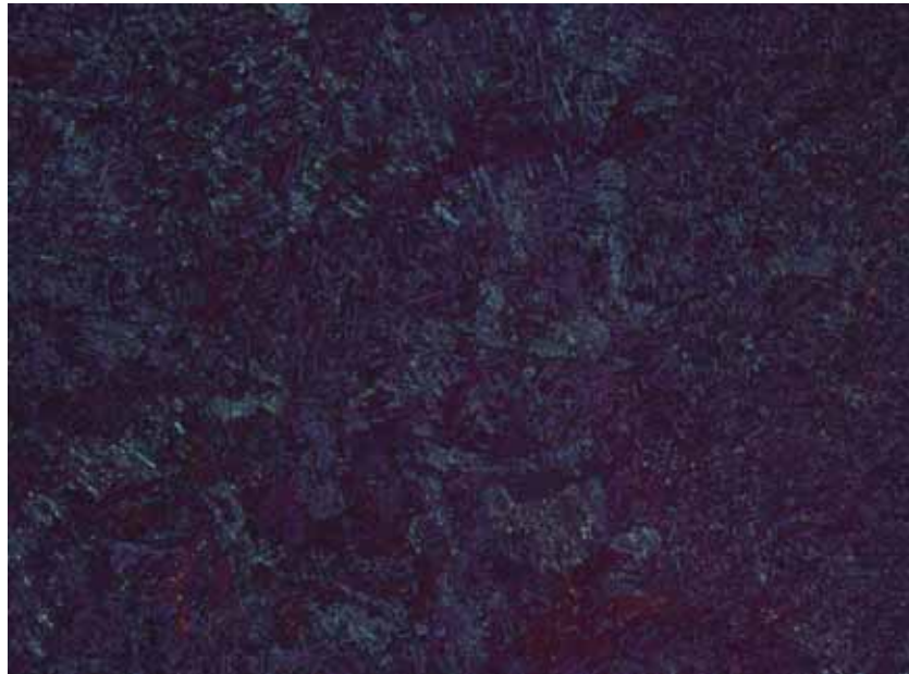
Figura 32: Corte Transversal – ZTA.
