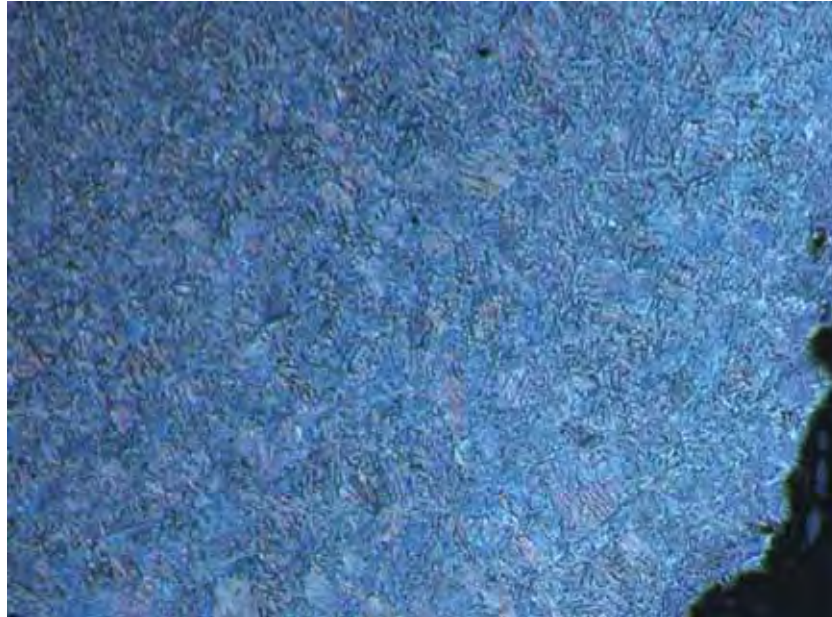
Figura 33: Corte Superficial - Região não afetada termicamente.
