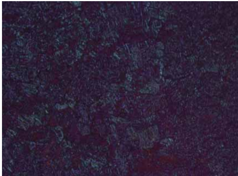
Figura 41: Corte Transversal - Região não afetada termicamente.
