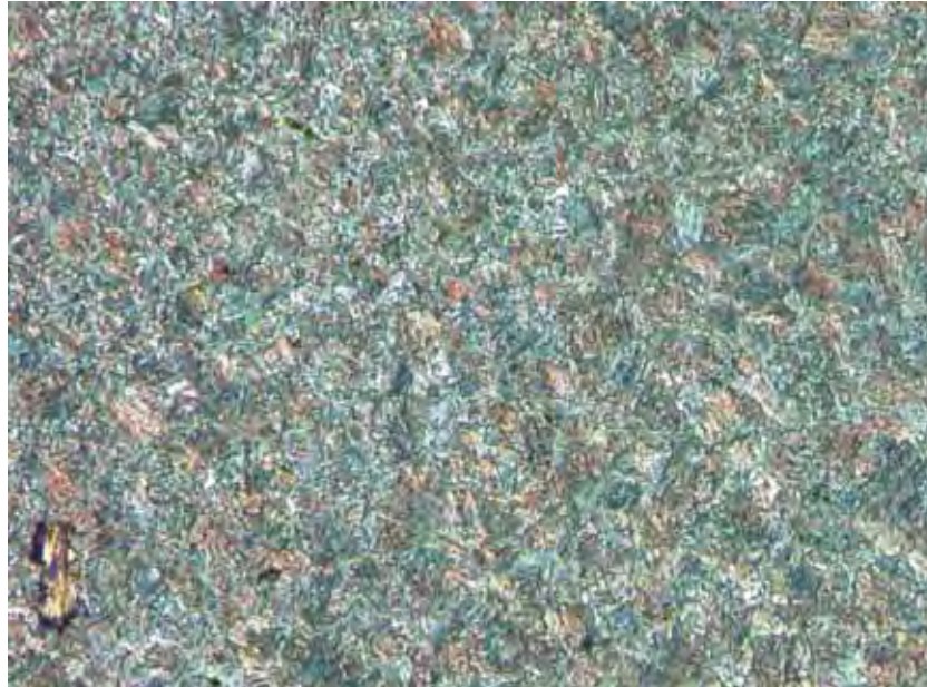
Figura 36: Corte Superficial - Região não afetada termicamente.
