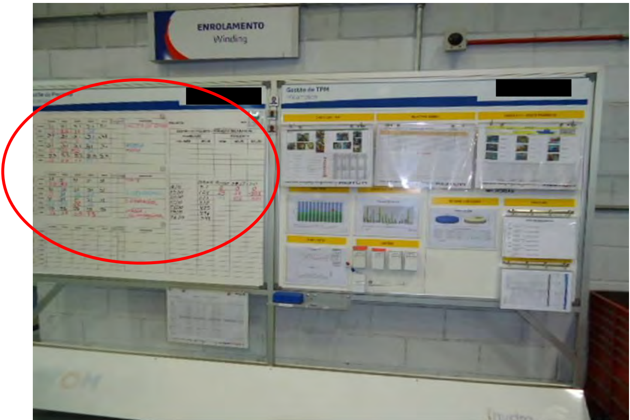
Figura 14- Quadro de gestão visual da máquina gargalo destacado as informações de produção.
