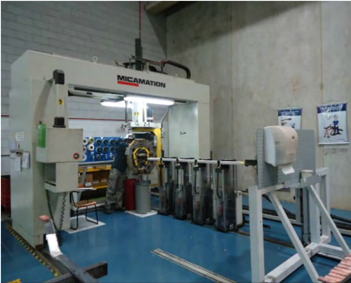
Figura 11- Isoladora Micamation, máquina gargalo.
