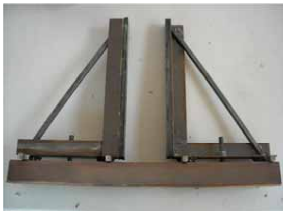
Figura 7 - Cavalete confeccionado para modelagem da viga
