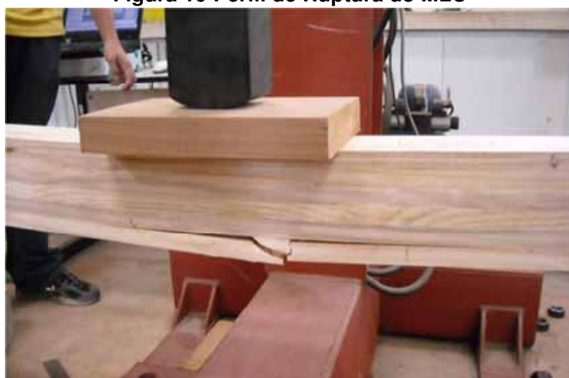
Figura 17 - Perfil de ruptura do MLCA
