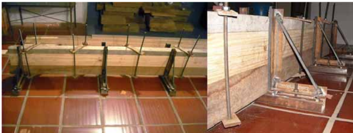
Figura 9 - Processo de colagem em andamento
