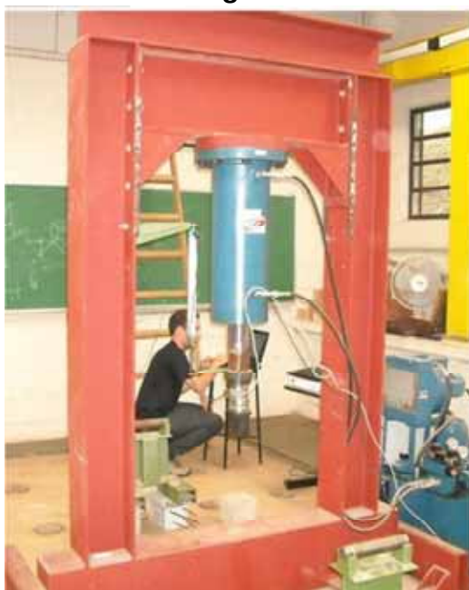
a) Pórtico para ensaios
