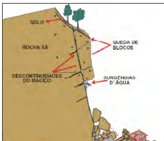
Figura 2 – Representação esquemática da queda de blocos (Fonte: Oliveira e Brito, 1998).
