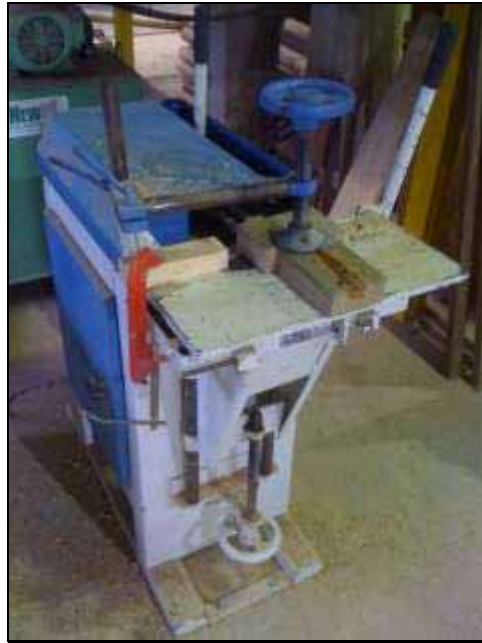
Figura 51 – Furadeira horizontal utilizada na furação dos corpos-de-prova
