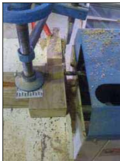
Figura 52 – Modelo de furação da base (alma) dos corpos-de-prova
