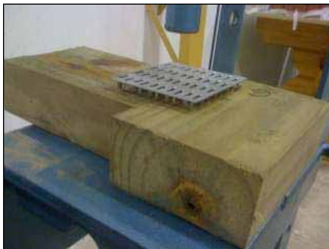
Figura 46 – Modo de prensagem dos conectores CDE
