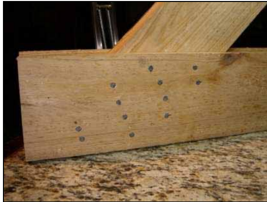
Figura 13 – Modelo de ligação por pregos Fonte: (UFPR-2007 Estruturas de Madeira)
