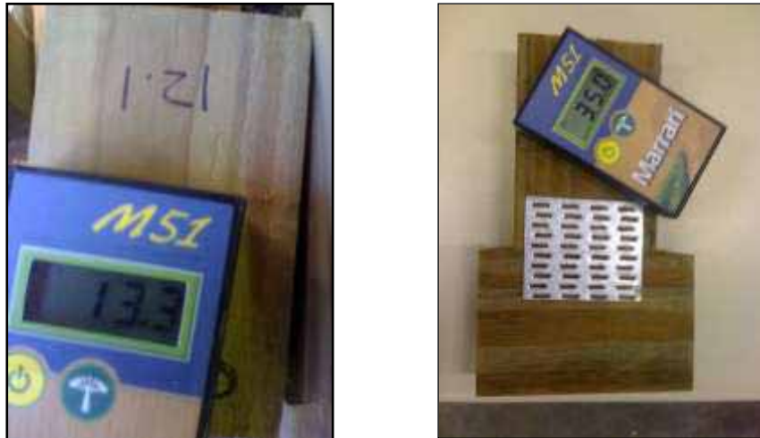
Figura 54 – Verificação da umidade antes do corpo-de-prova ser ensaiado.
