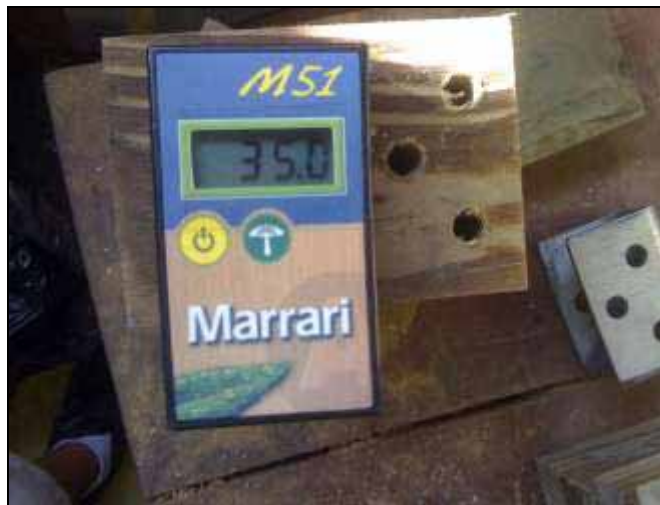
Figura 27 – Medidor de umidade da marca Marrari
