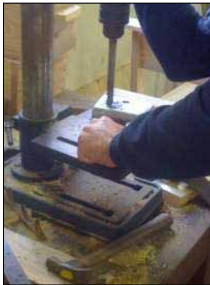
Figura 34 – Furação do conector para ensaio
