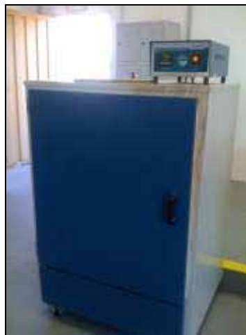
Figura 53 – Estufa de secagem utilizada no processo de secagem dos corpos-de-prova
