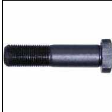
Figura 37 – Parafuso utilizado para fixação dos corpos-de-prova com o dispositivo
