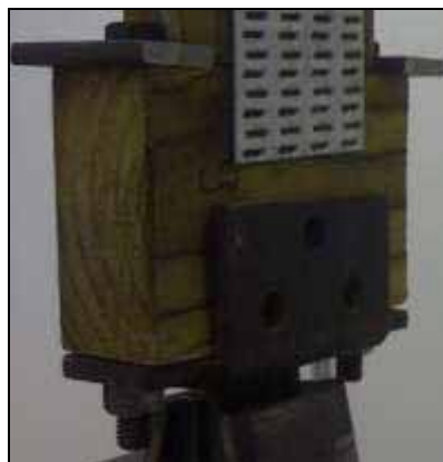
Figura 36 – Dispositivo conectado na parte inferior dos corpos-de-prova
