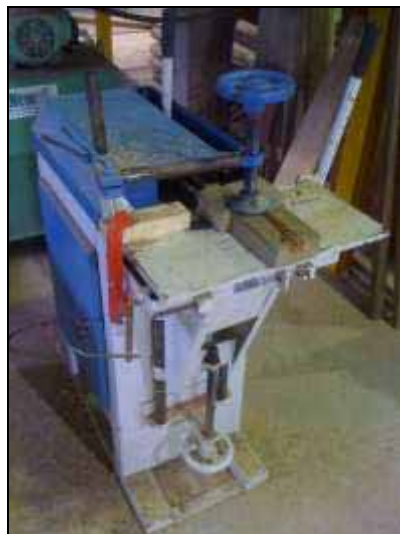
Figura 31 – Furadeira horizontal utilizada na furação dos corpos-de-prova
