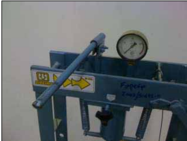
Figura 45 – Alavanca da prensa manual utilizada para a prensagem dos corpos-de-prova
