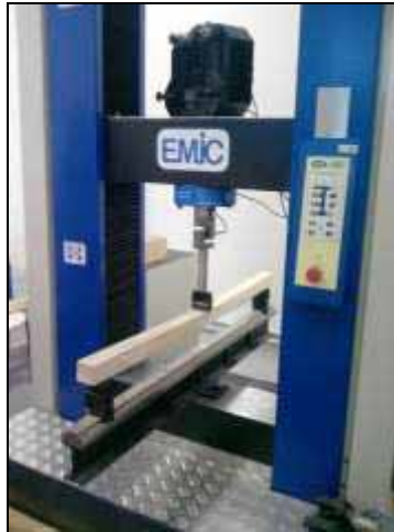
Figura 28 – Máquina de ensaio laboratorial EMIC com capacidade máxima de 300 kN
