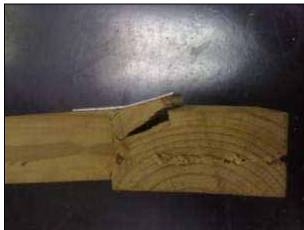
Figura 58 – Exemplo de deformação do corpo de prova.
