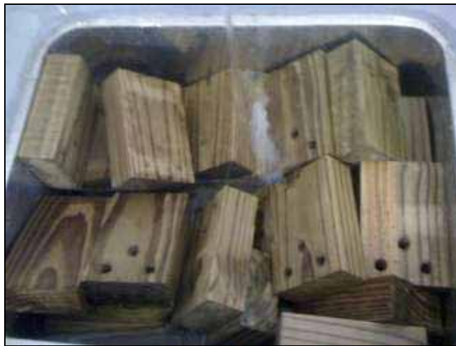
Figura 44 – Peças já furadas imersa no tanque do laboratório de propriedades mecânicas
