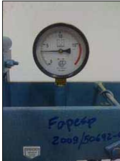
Figura 49 – Calibração da força aplicada em cada corpo-de-prova
