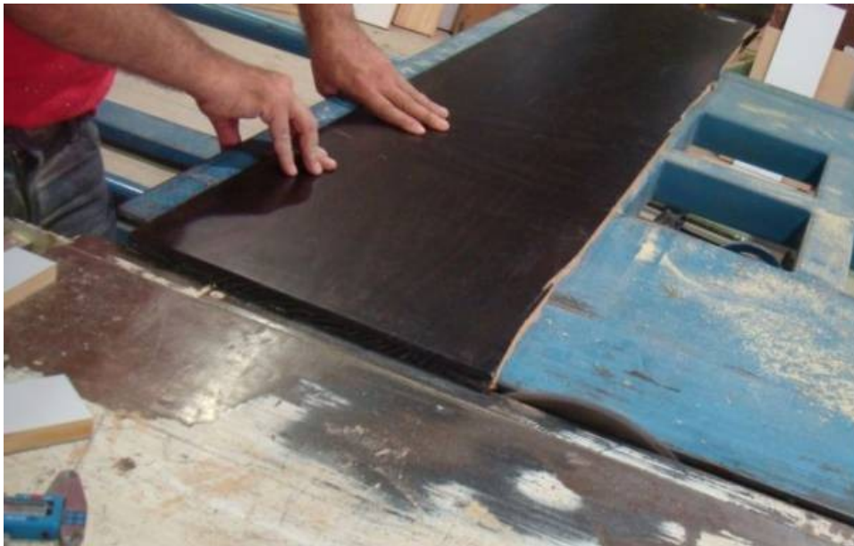
Figura 3: Serra esquadrejadeira com eixo de inclinado de 40° a 90°.
