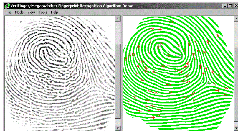
Figura 6 - Impressão de baixa qualidade (a esquerda) e após a aplicação do filtro adaptativo (a direita).
