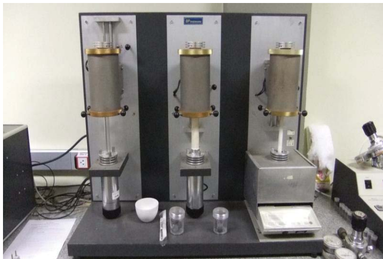
Figura 9 - Equipamento de análises térmicas (BP Engenharia). Da esquerda pra direita: Dilatômetro, DTA e TG.
