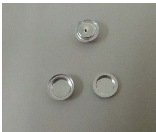
Figura 14 – Cadinhos de alumínio utilizados no DSC.
