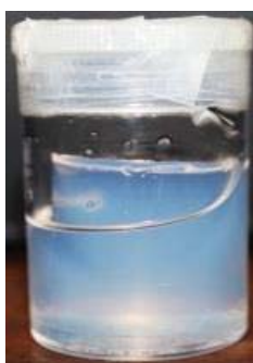
Figura 5 – Foto mostrando um Gel úmido de TEOS com a fase líquida em seu redor.
