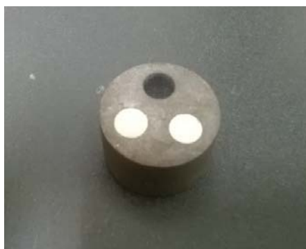
Figura 12 – Cadinho que comporta a amostra no aparelho de DTA. Os compartimentos preenchidos com pó branco (alumina) são usados como referencia na medida.
