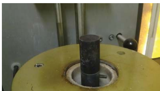
Figura 10 – Cadinho que comporta a amostra dentro do forno do aparelho de TG.
