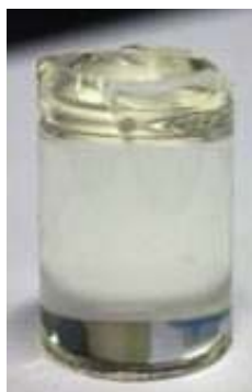
Figura 6 – Foto de um Xerogel monolítico de TEOS, obtido pela secagem controlada de um gel.
