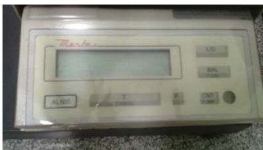
Figura 11 – Balança de precisão acoplada no aparelho de TG.
