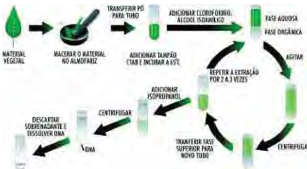
Figura 3. Esquema representativo das etapas de extração de DNA genômico. Fonte: CENARGEN/Embrapa Recursos Genéticos e Biotecnologia
