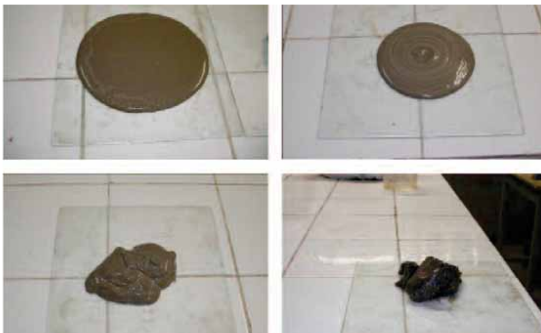
Figura 2 – Pasta do mesmo cimento Portland com diferentes relações água/cimento: da esquerda para direita e de cima para baixo: 0,60, 0,50, 0,40 e 0,30.
