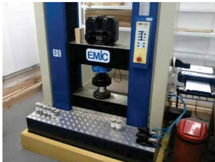
Figura 15 – Máquina de ensaios universal (EMIC).
