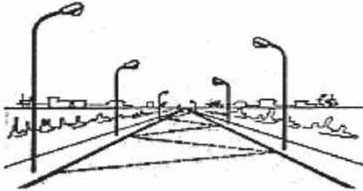
Figura 19 – Disposição bilateral alternada de luminárias (VOLTIMUM, 2002)
