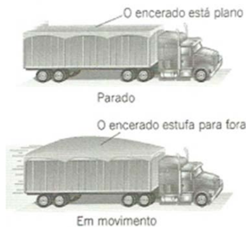
Figura 4.7 – O encerado permanece plano quando o caminhão está parado e quando está em movimento o encerado estufa. Fonte: Cutnell e Johnson (2006, p.347).
