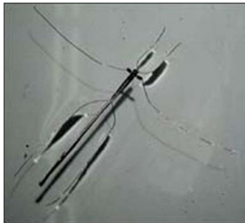
Figura 3.21 – Robostrider, um robô criado por um grupo de pesquisadores do MIT, robô este que imita a capacidade que alguns insetos possuem de caminhar sobre a água. Disponível em: < http://news.bbc.co.uk >. Acesso em: 24 set. 2011.
