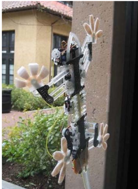
Figura 2.31 – O robô Stickybot, que reproduz a habilidade das lagartixas, é capaz de subir em paredes lisas. Disponível em: < http://www.inovacaotecnologica.com.br >. Acesso em: 17 ago. 2011.
