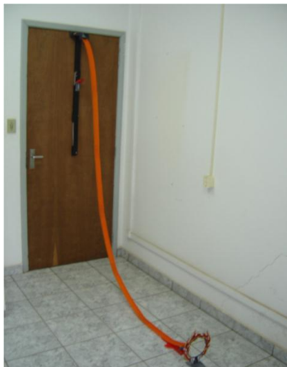
Figura 2 - Montagem da pista e do elevador do brinquedo - Carrinho Saltador, uma das extremidades da pista fica presa na porta e a outra livre no chão.
