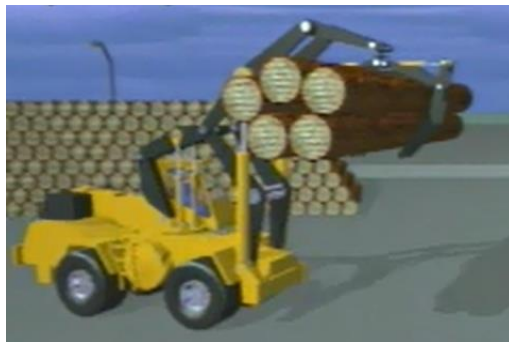
Figura 3 – Máquina transportadora de toras (adaptado de Siempelkamp, 2009.)
