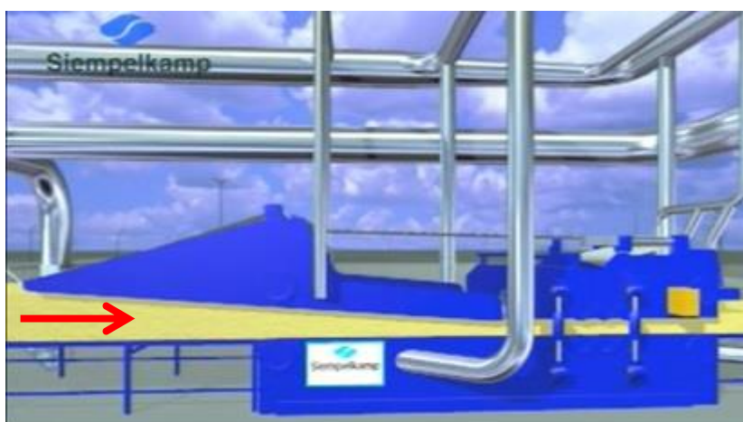
Figura 10 – Desaeração e compactação do colchão (Siempelkamp, 2009.)
