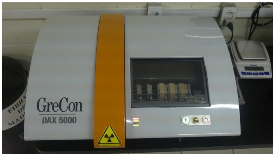
Figura 22 - Equipamento para determinação de perfil de densidade
