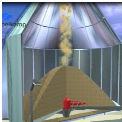
Figura 5 – Silo de cavaco de madeira (adaptado de Siempelkamp, 2009.)
