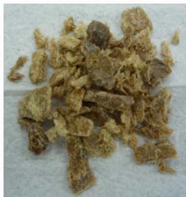
Figura 11-Compósito de poliestireno expandido reciclado/ 25% sisal.
