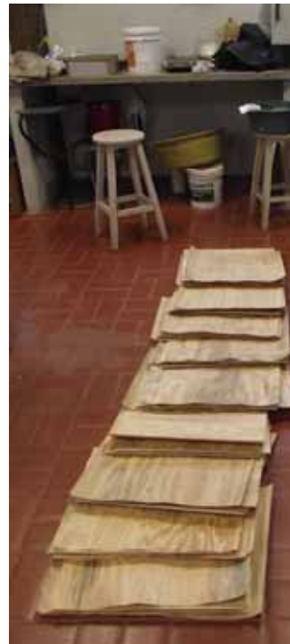
Figura 10 – Grupos de lâminas separadas, ordenadas e nomeados após a pesagem antes da aplicação do adesivo.
