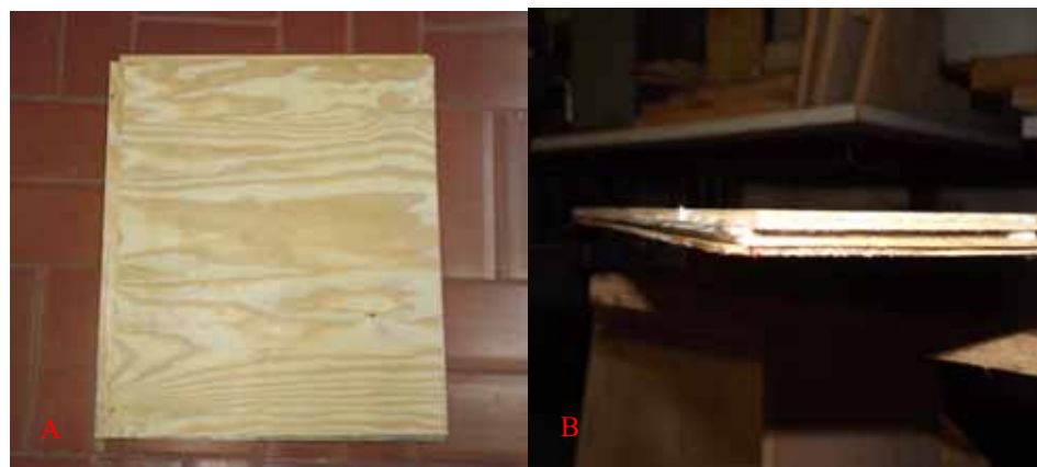
Figura 14.A – Vista superior do painel montado após processo da prensagem. B – Vista lateral do painel após prensagem.
