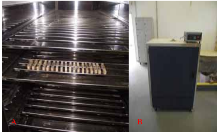
Figura 16.A – Corpos de prova após secagem em estufa; B – Estufa utilizada para realização dos ensaios.
