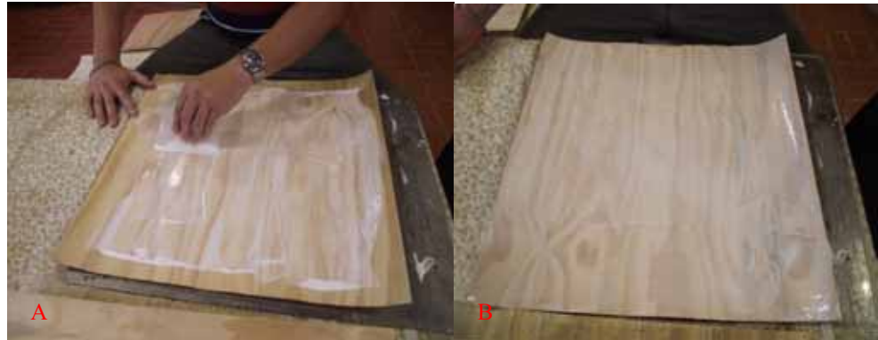
Figura 11.A – Aplicação do adesivo. B – Lâmina com o mesmo aplicado.
