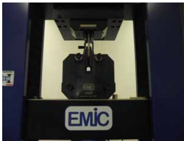
Figura 26 – Ilustração do ensaio de cisalhamento na linha de cola.
