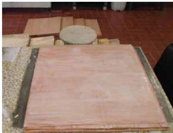
Figura 12 – Painel montado antes da etapa da prensagem.
