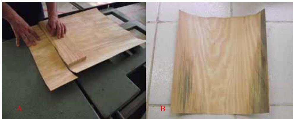
Figura 7.A – Esquadrejamento da lâmina. B – Lâmina nas dimensões desejadas.
