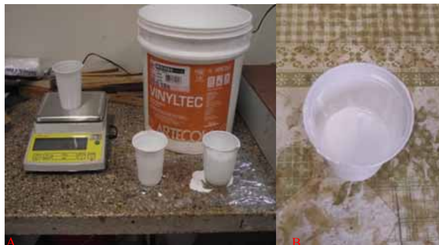
Figura 9.A – Balança analítica utilizada para a pesagem dos adesivos. B – Copo plástico descartável utilizado para separação da quantidade de cola necessária para cada camada.
