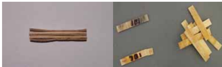
Figura 28 – Corpo de prova parcialmente (esquerda) e completamente (direita) delaminado.
