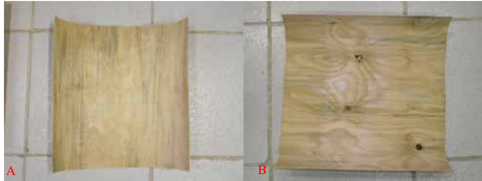
Figura 8.A – Lâmina classificada como isenta de defeitos. B – Lâmina com nós e pequenas rachaduras.
