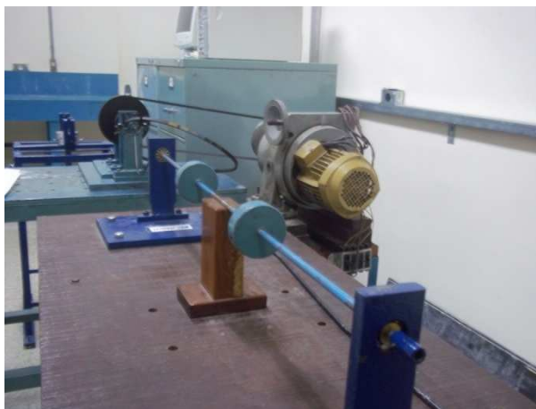
Figura 10 – Eixo e cargas concentradas no experimento 1
