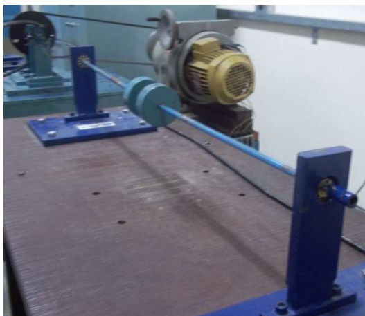
Figura 13 – Eixo e massas concentradas no experimento 2
