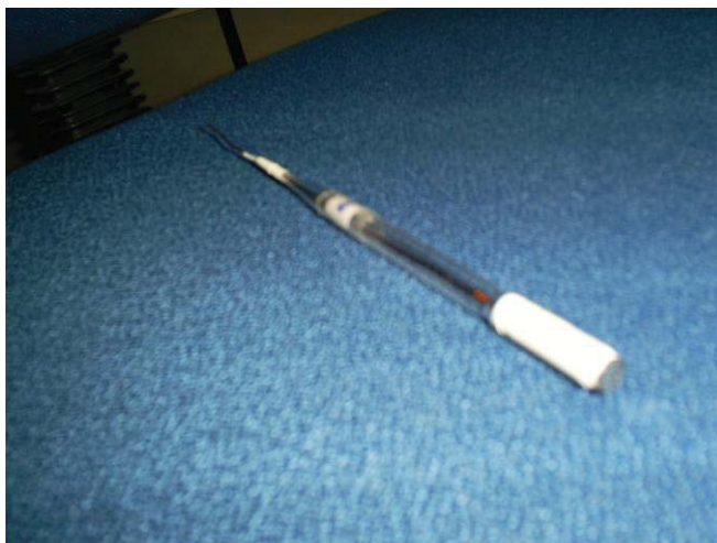
Figura 4: eletrodo montado para utilização na configuração de menisco
