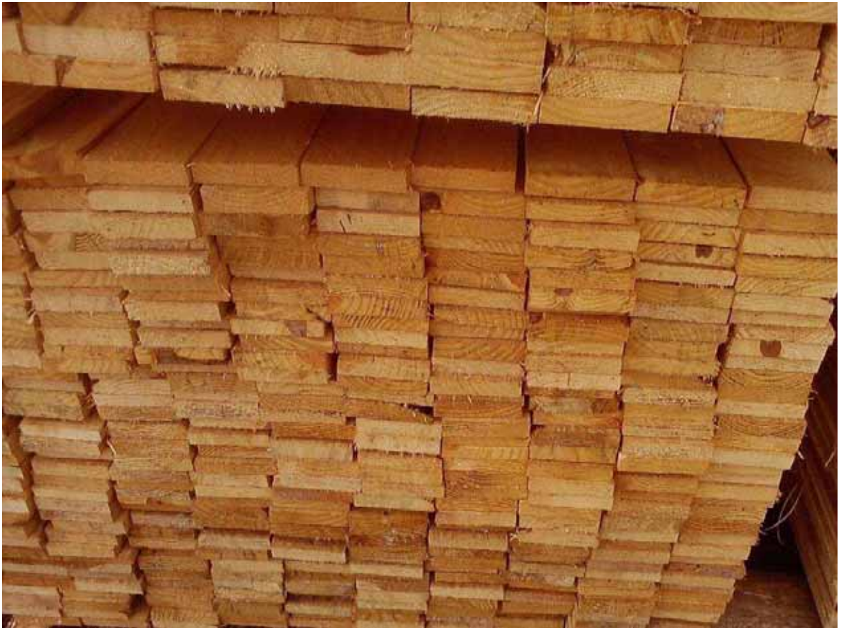
Figura 6 – Tábuas de 21mm de espessura por 100mm de largura.
