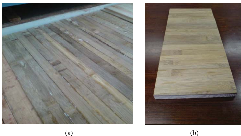
Figura 25: (a) Prancha de bambu na mesa formadora e (b) Piso engenheirado sem prensado
