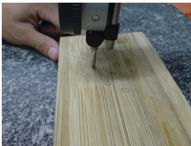
Figura 32: Sulco provocado durante o ensaio e a aquisição dos dados.
