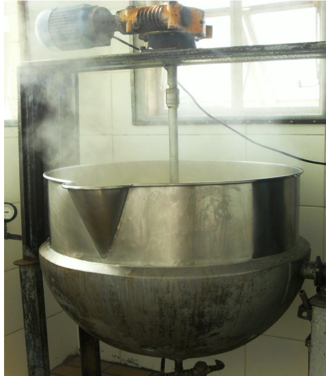
Figura 9 – Fotografia da máquina bateadeira utilizada durante a produção de requeijão.
