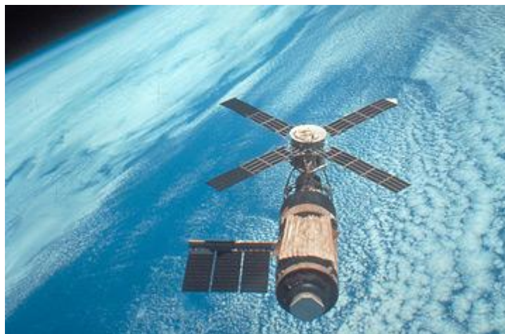
Figura 3 - Satélite “Skylab” e seus painéis solares de 20 kW.
