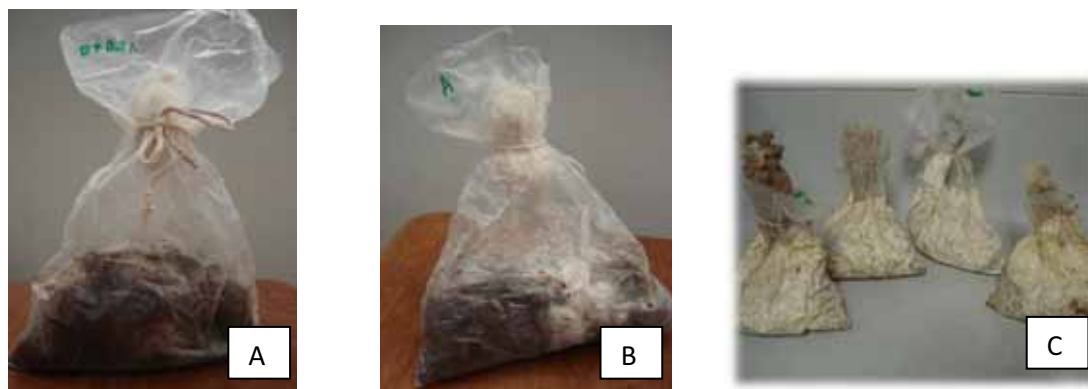
Figura11: Bagaço de cana termo explodido inoculado com o fungo após 5 dias: (A) sem a adição; (B) com adição de carbonato; (C) com a adição de do carbonato de cálcio e farelo de aveia.
