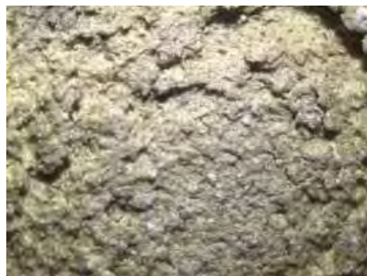
Figura 102 – Detalhe da camada de titânia (8X)
