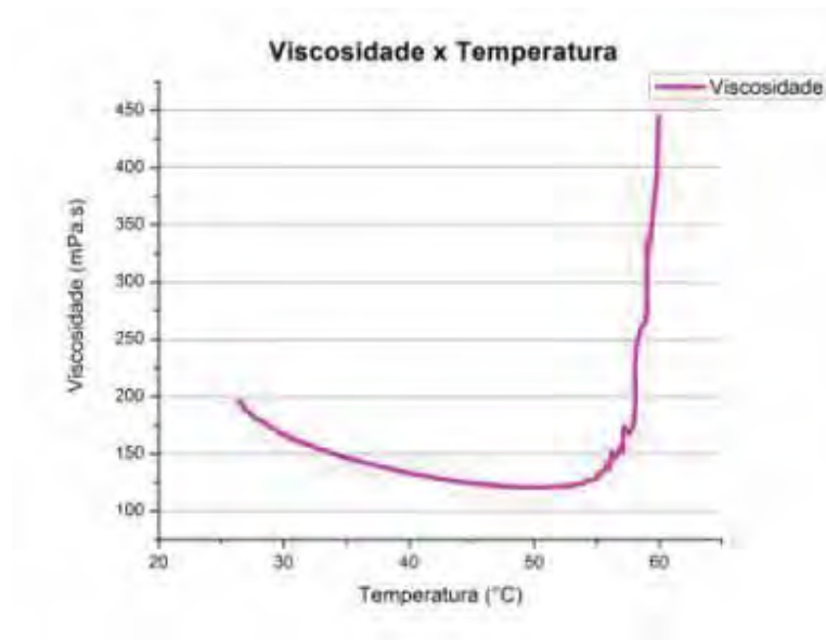
Figura 37 – Gráfico da viscosidade em função do aumento da temperatura para a titânia com o amido de batata – fuso SC4-18
