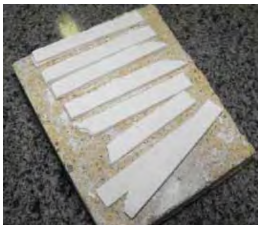
Figura 56 – Pastilhas prensadas de alumina com titânia
