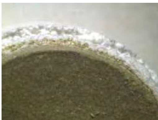
Figura 91 – Camada de alumina antes do choque térmico (8X)
