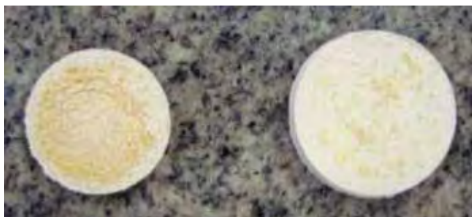
Figura 62: Vista superior das camadas separadas da pastilha
