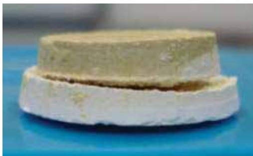
Figura 61 – Vista frontal da pastilha com o titanato errado
