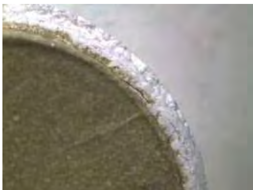
Figura 74 – Vista frontal da fratura (8X)
