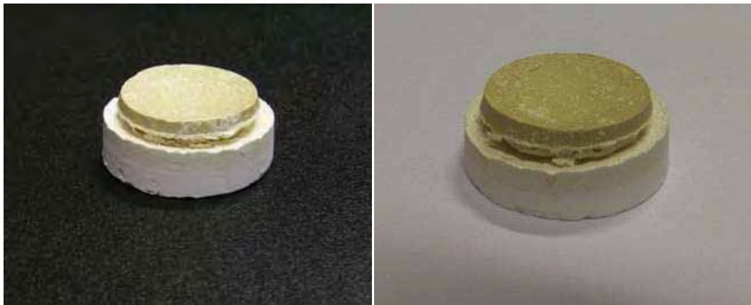
Figura 64 – Pastilhas após a sinterização à 1450°C
