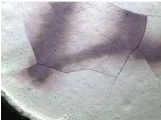
Figura 89 – Pastilha antes do choque térmico (8X)
