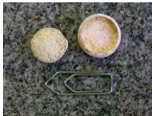
Figura 88 – Camadas separadas da pastilha
