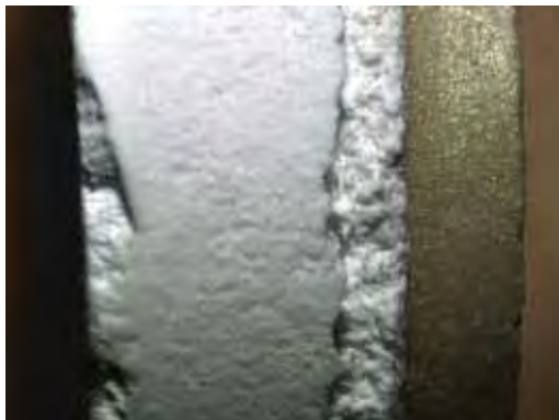
Figura 93 – Lateral da pastilha antes do choque térmico (8X)
