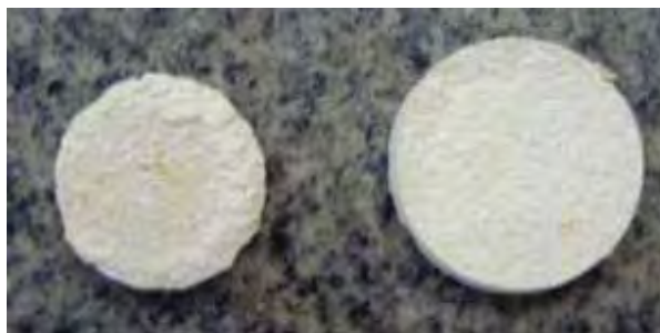
Figura 66-a – Camadas separadas da pastilha
