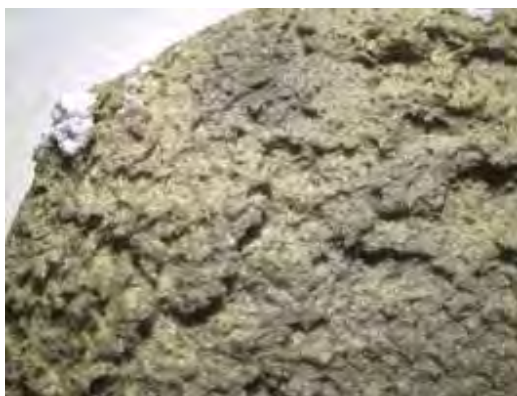
Figura 101 – Camada de titânia não aderida à pastilha (8X)
