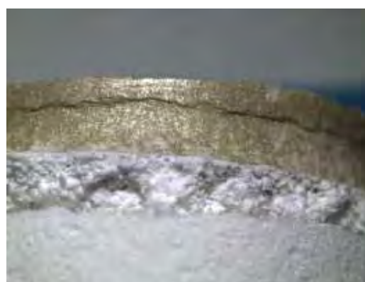
Figura 77 – Vista lateral da fratura na camada (8X)
