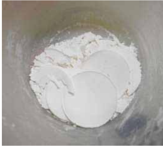
Figura 55 – Película retirada da camada de alumina após a secagem desta
