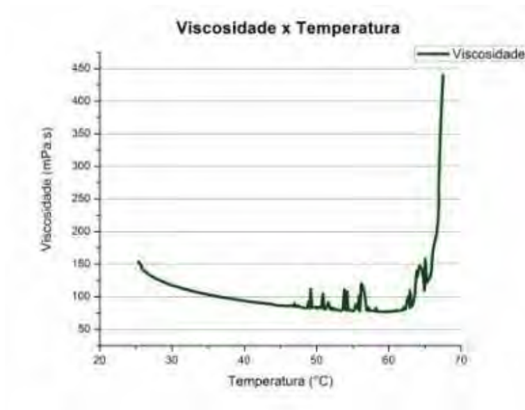
Figura 41 – Gráfico da viscosidade em função do aumento da temperatura para a titânia com o amido de milho – fuso SC4-18
