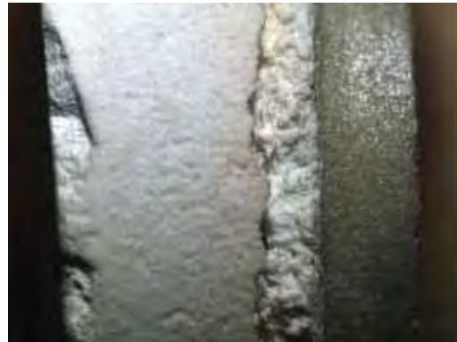
Figura 94 – Lateral da pastilha após o choque térmico (8X)
