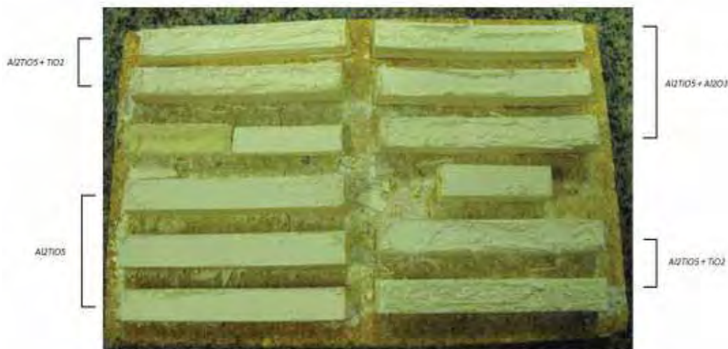
Figura 58 – Pastilhas prensadas uma única vez
