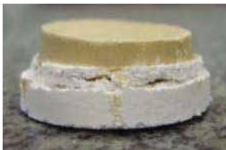
Figura 67 – Vista lateral com titanato de alumínio do quarto lote
