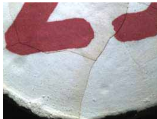
Figura 90 – Pastilha depois do choque térmico (8X)
