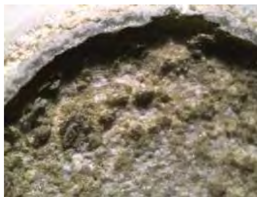
Figura 98 – Camadas separadas (8X)
