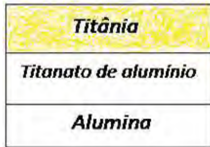
Figura 22 – Esquema das camadas das pastilhas
