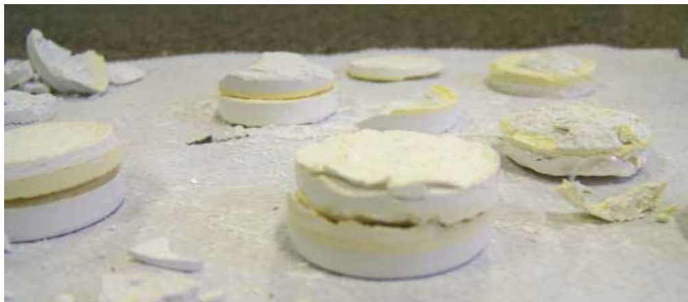
Figura 51 – Pastilhas cerâmicas produzidas por conformação com amido após a pré-sinterização (1000°C)
