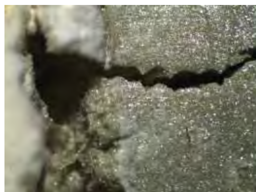
Figura 96 – Detalhe da trinca com aumento de 32X
