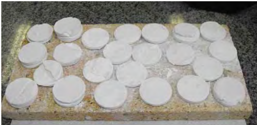
Figura 53 – Pastilhas após a última secagem com as camadas não aderidas
