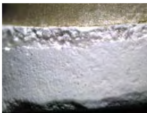
Figura 71 – Perfil das camadas da pastilha (8X)
