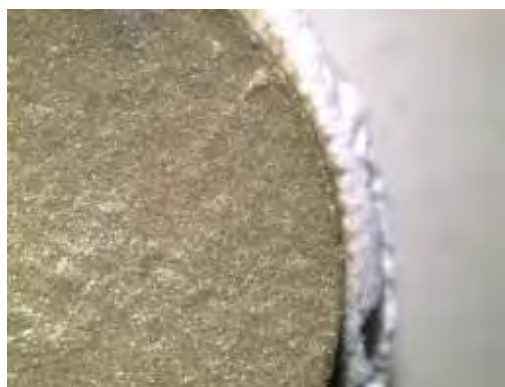
Figura 75 – Vista frontal da camada de titânia (8X)
