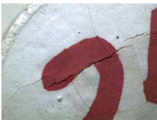
Figura 78 – Trinca na camada de alumina
