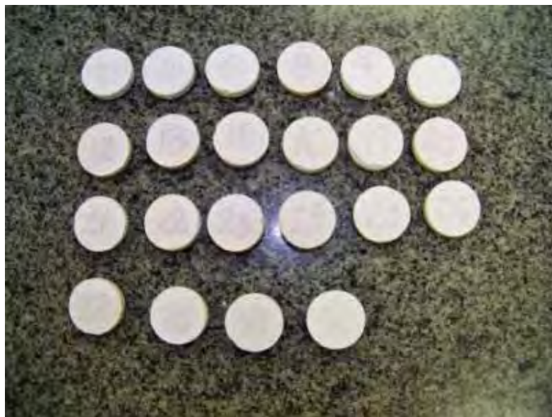
Figura 83 – Pastilhas que ficaram intactas após o choque térmico
