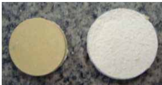
Figura 66 - b – Camadas separadas da pastilha
