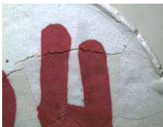
Figura 79 – Trinca na camada de alumina pós choque térmico
