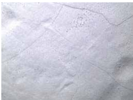
Figura 72 – Trincas na camada de alumina (8X)
