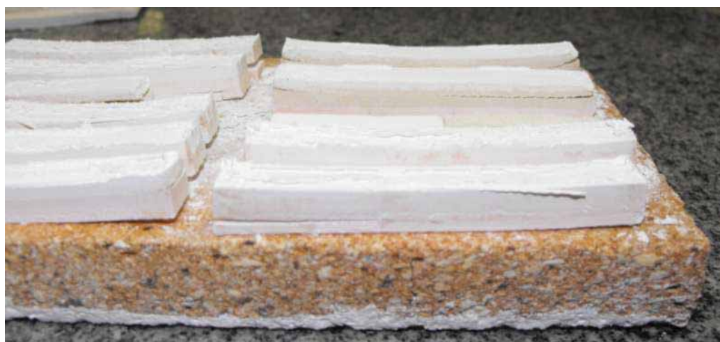
Figura 59 – Pastilhas prensadas uma única vez com ligeiro descolamento das camadas e empenamento
