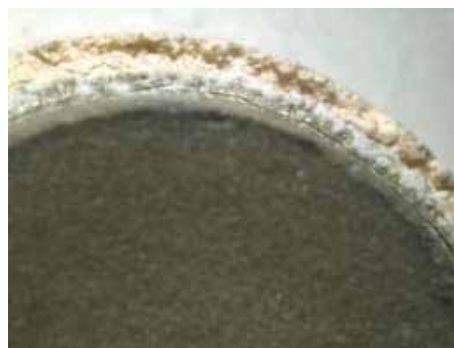
Figura 92 – Camada de alumina pós choque térmico (8X)
