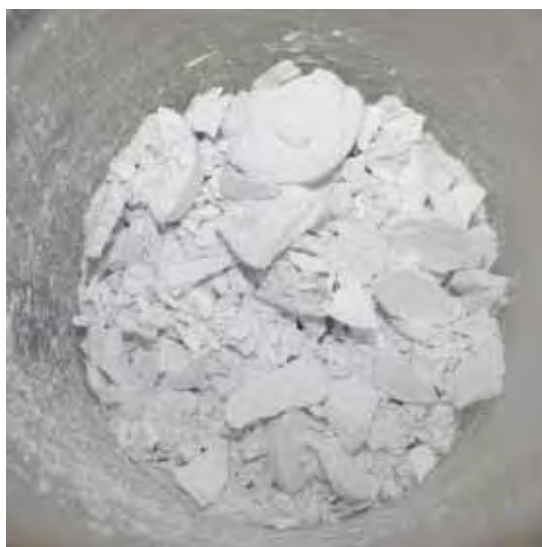
Figura 54 – Pastilhas fragmentadas após a última secagem
