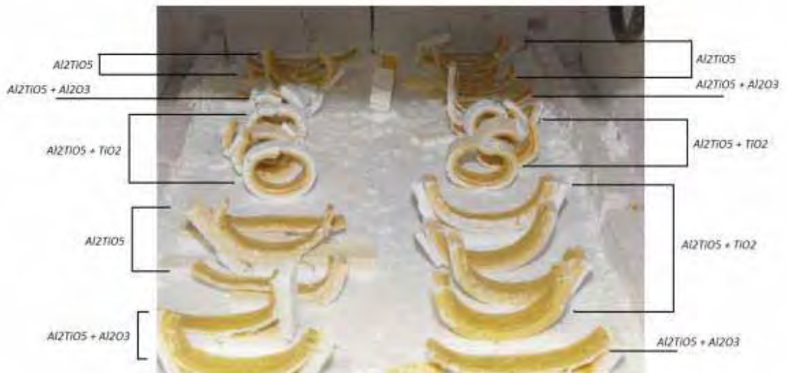
Figura 60 – Pastilhas sinterizadas dentro do forno
