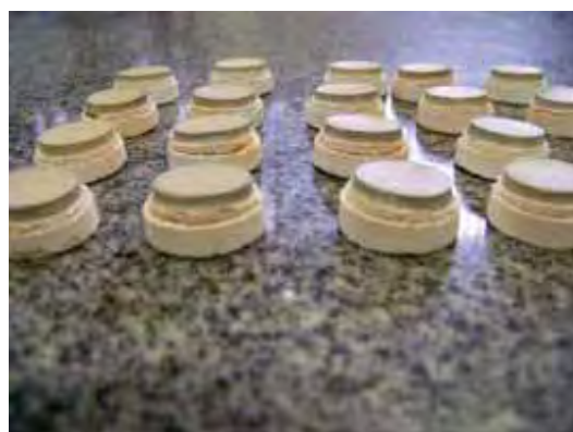
Figura 85 – Vista frontal das pastilhas após o choque térmico
