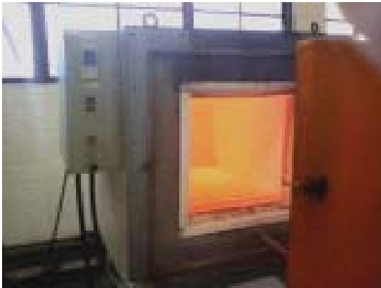
Figura 16 – Forno utilizado para solubilização do INCONEL 718.
