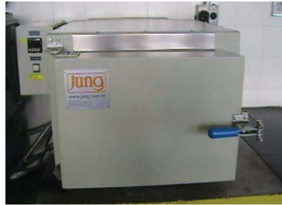
Figura 17 – Forno utilizado para precipitação do INCONEL 718.
