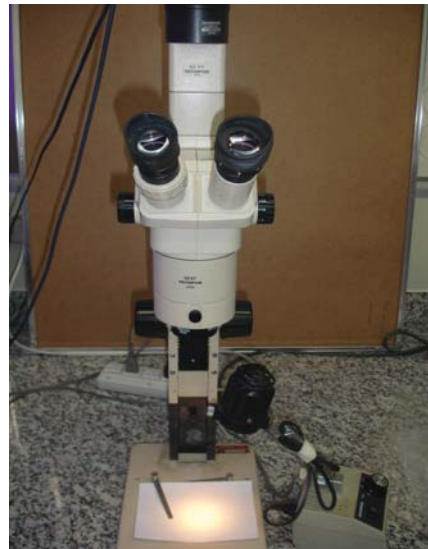
Figura 19 – Estereoscópio utilizado para registrar o desgaste nas ferramentas.
