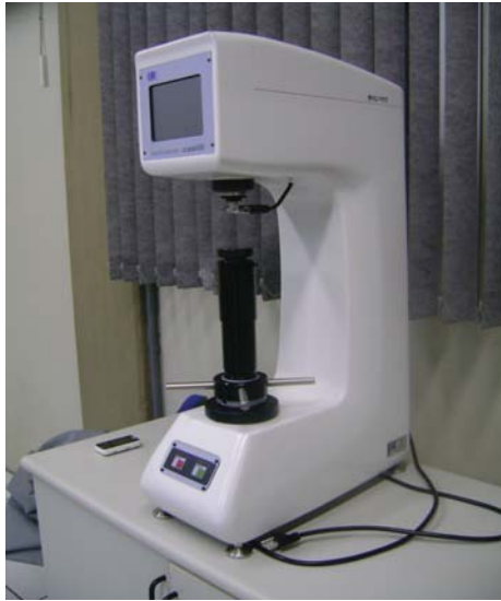
Figura 18 – Duromêtro digital utilizado para medir a dureza.
