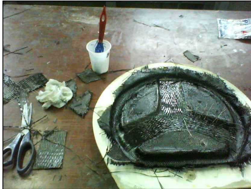
Figura 13: Processo de laminação manual na parte inferior do molde do volante.
