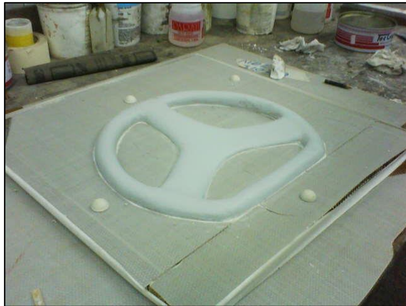
Figura 12: Preparação do molde do volante.
