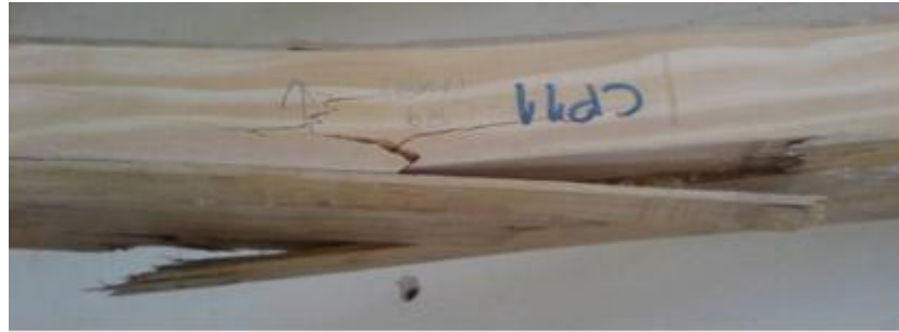
Figura 28 - Aspecto do rompimento em um corpo-de-prova com reforço de bambu.
