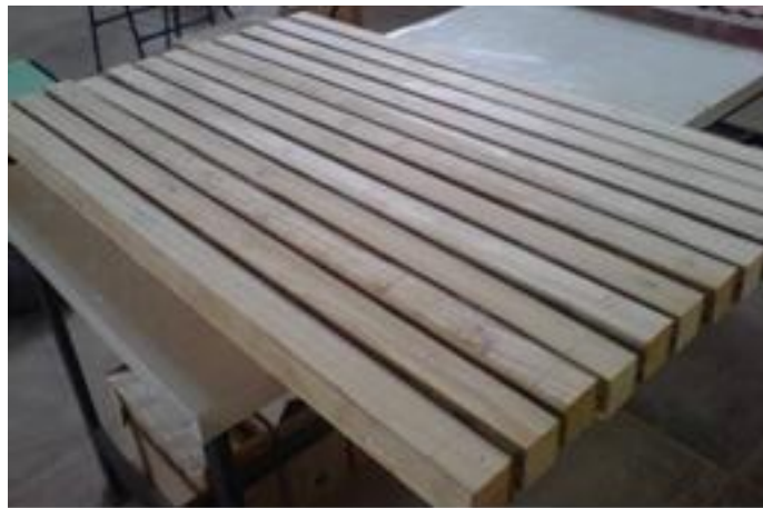
Figura 19 - Corpos-de-prova de EGP com reforço de bambu Guadua angustifolia .
