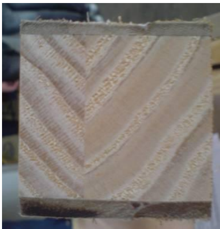
(a) EGP com linha de cola vertical e com reforço de bambu.
