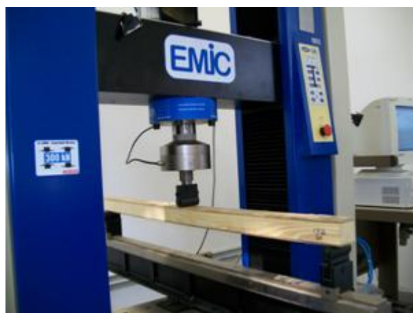
Figura 24 - Ensaio de flexão estática.
