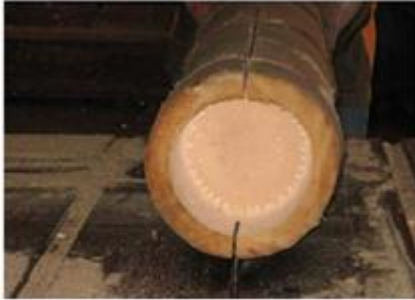
(a) Colmo sendo seccionado no sentido longitudinal por uma serra circular.
