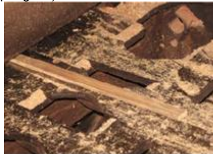
(e) Processamento das taliscas na plaina desengrossadeira, para obtenção das lâminas.
