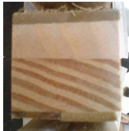
(b) EGP com linha de cola horizontal e com reforço de bambu.
