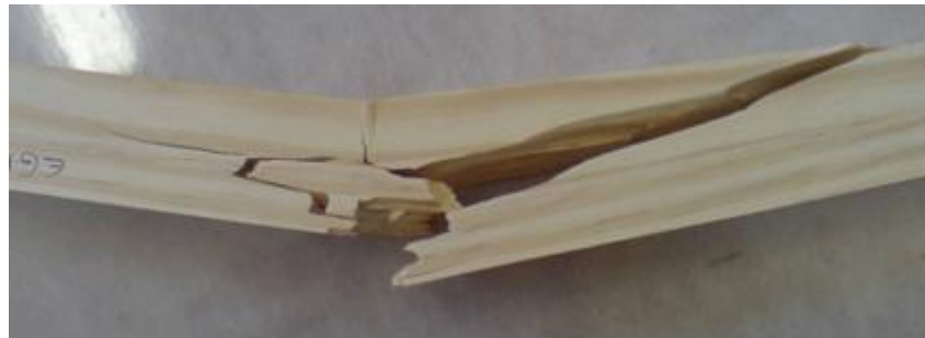
Figura 29 - Aspecto do rompimento nos corpos-de-prova de referência de EGP sem reforço de bambu.
