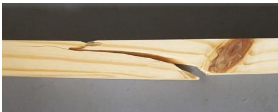
Figura 33 - Aspecto do rompimento nos corpos-de-prova de madeira maciça sem reforço de bambu.
