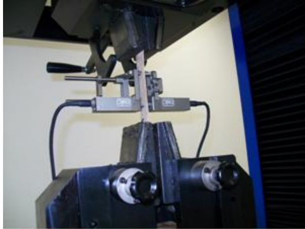
Figura 23 - Ensaio de tração paralela às fibras.
