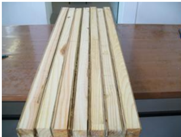
Figura 21 - Material composto viga maciça com reforço de bambu.
