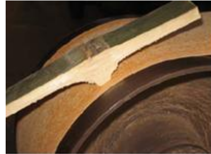
(d) Retirada do diafragma em uma lixadeira.
