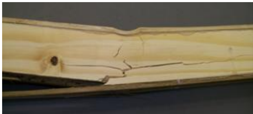
Figura 32 - Aspecto do rompimento em um corpo-de-prova de madeira maciça com reforço de bambu.
