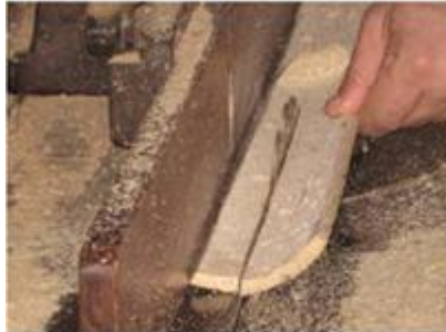
(c) Transformação do material em ripas em uma serra circular (operação perigosa).
