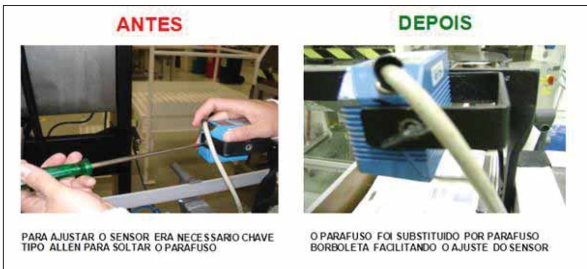
Figura 3: Substituição do parafuso allen por parafuso borboleta.
