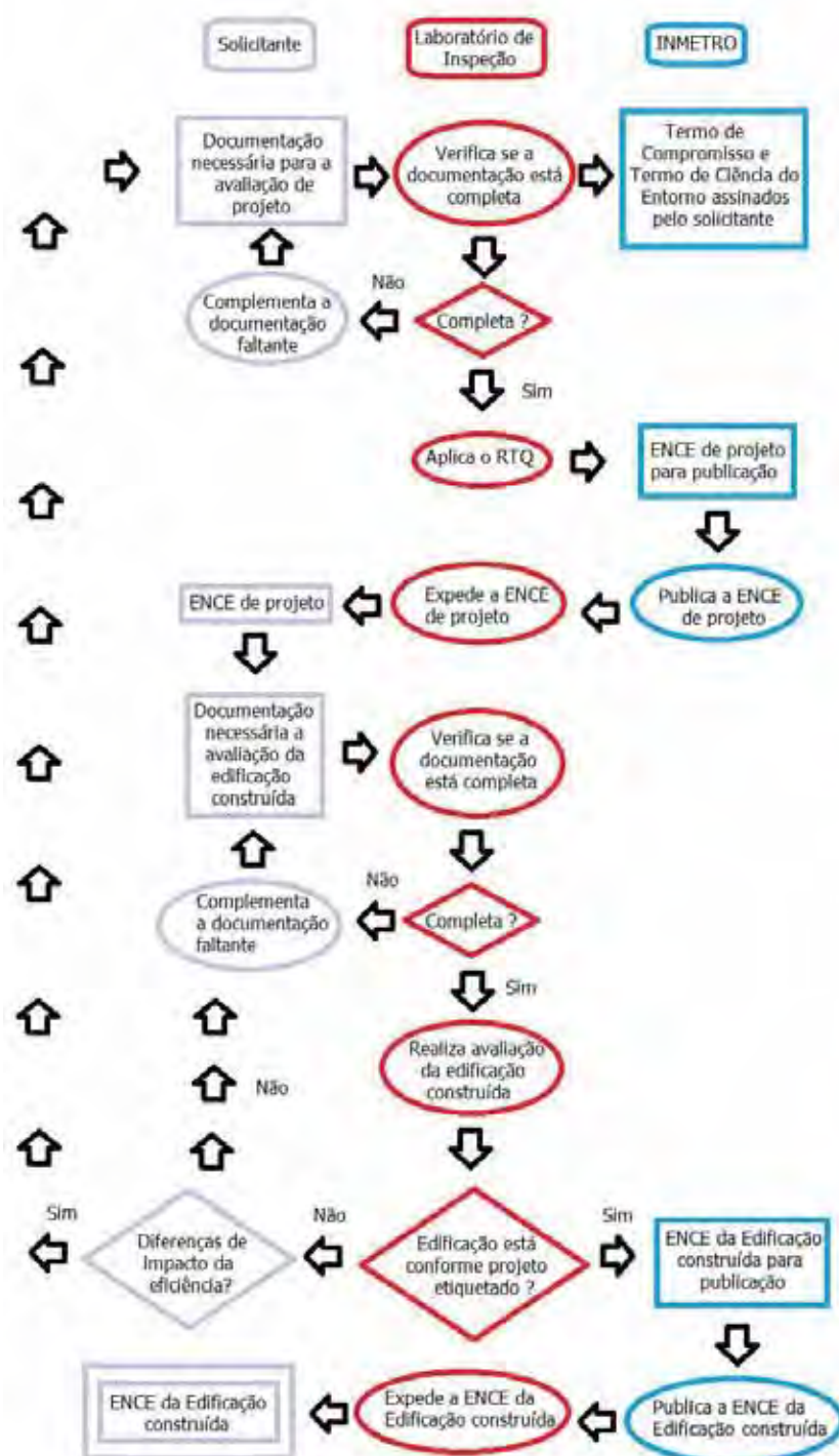
Figura 2.2 - Fluxograma do Processo de Avaliação da Conformidade (INMETRO, 2011)
