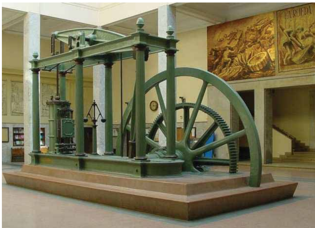
Figura 1.1 - Máquina a vapor de James Watt (CAMBRIDGE PHYSICS, s.d)
