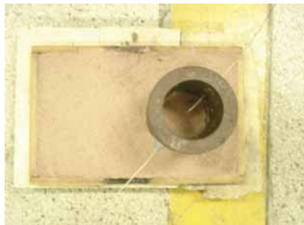
Figura 18 Disposição dos termopares no molde metálico
