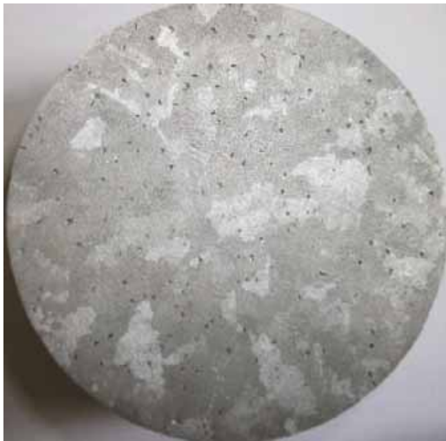
Figura 14 Macroestrutura da liga AA 356 obtida em molde de areia
