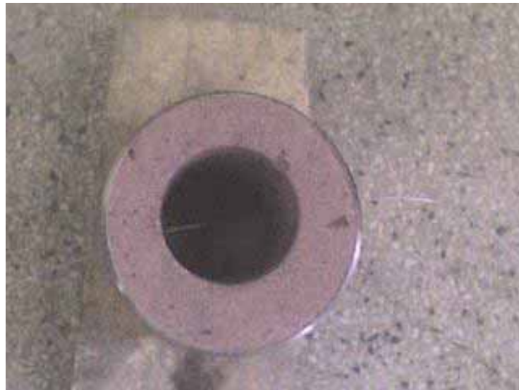
Figura 6 Molde de Areia Com os Termopares
