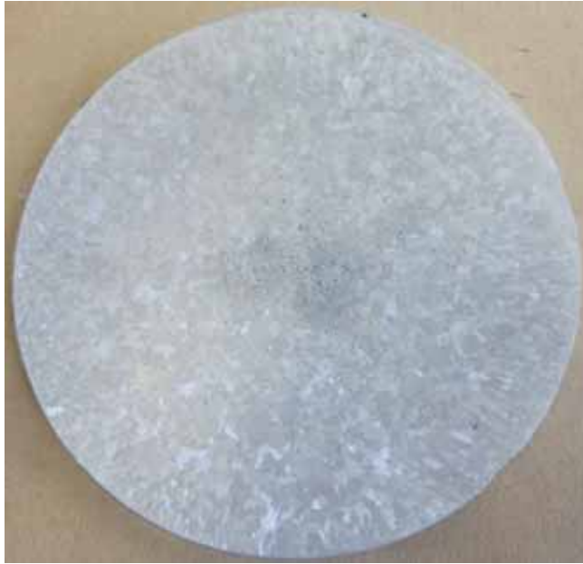
Figura 13 Macroestrutura da liga AA 356 obtida em molde metálico
