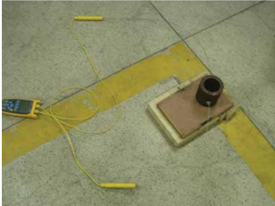
Figura 7 Molde Metálico com Termopares e Termômetro
