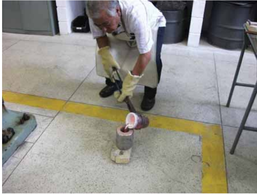
Figura 8 Vazamento da Liga AA 356 no Molde de Areia
