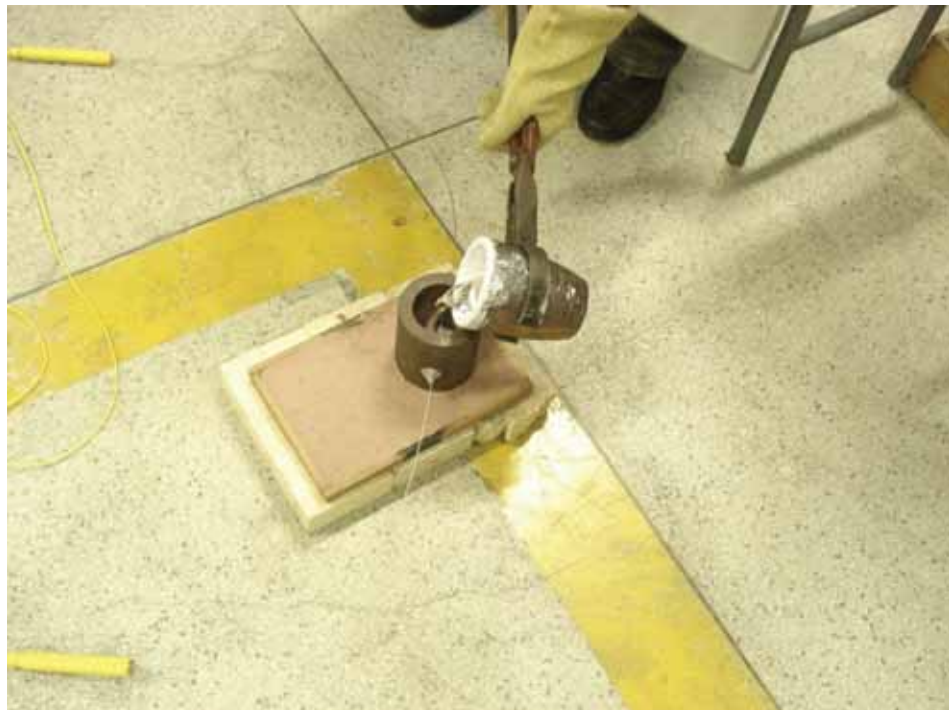
Figura 9 Vazamento da Liga AA 356 no Molde Metálico
