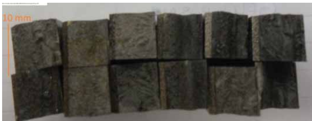
Figura 8.3: Corpo de prova após o ensaio charpy a -78^{\circ}\text{C} .
