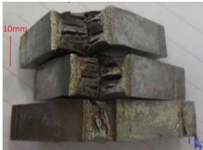
Figura 8.1: Corpo de prova após o ensaio charpy a 0^{\circ}\text{C} .
