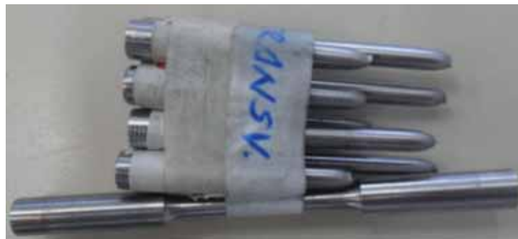
Figura 8.17: Corpos de prova transversal após o ensaio e um corpo de prova sem ser ensaiado.
