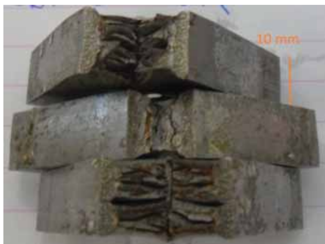
Figura 8.5: Corpo de prova após o ensaio charpy a uma temperatura que não pode ser definida.
