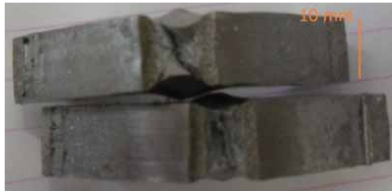
Figura 8.2: Corpo de prova após o ensaio charpy a -21^{\circ}\text{C} .
