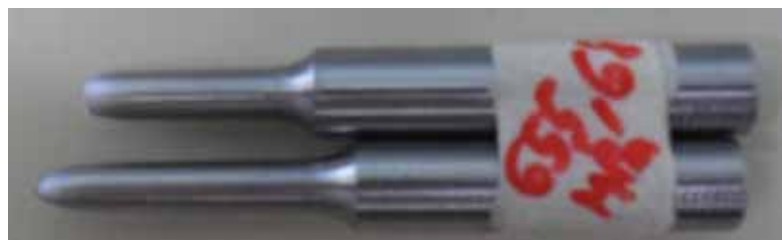
Figura 8.16: Corpo de prova longitudinal após o ensaio.
