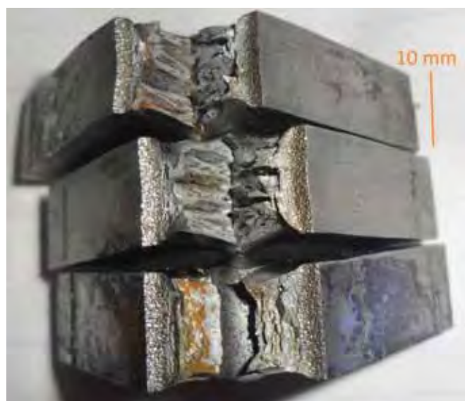
Figura 8.3: Corpo de prova após o ensaio charpy a -78^{\circ}\text{C} .
