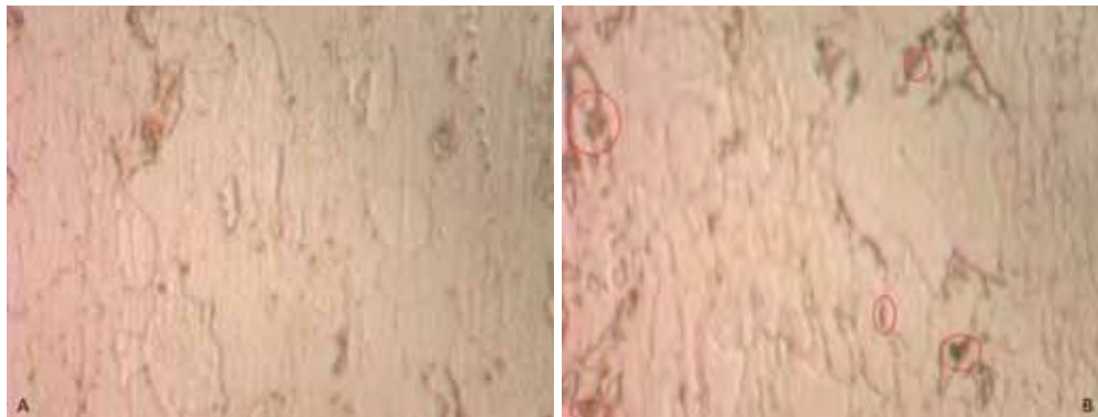
Figura 8.19: metalografia da amostra em corte longitudinal. A figura A mostra os contornos de grãos da ferrita e na figura B as parte circuladas são as perlitas do material.
