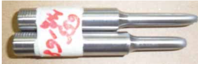
Figura 8.15: Corpo de prova longitudinal após o ensaio.
