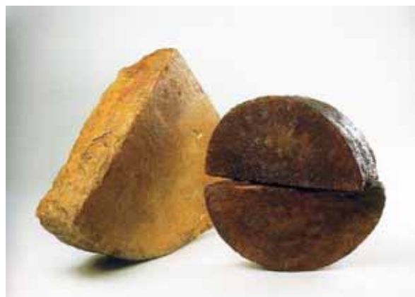
Figura 6: Tijolos semicirculares. 25 cm; 16 cm de raio (da esquerda para a direita) 6 . Foto: Rômulo Fialdini. Fonte: MALTA et al, 2009, p.71
