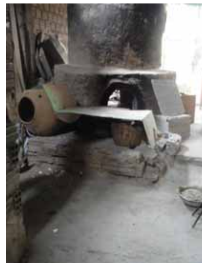
Figura 10: Forno a lenha de cúpula aberta, para peças menores. Ateliê “Bosque das Estrelas”, pertencente à Teresinha e Gonzaga. Foto da autora.
