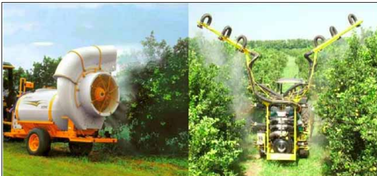
Figura 2. Modelos dos equipamentos utilizados nos experimentos para a avaliação do pulverizador envolvente. À esquerda, pulverizador Arbus 2000 (Fonte: Máquinas Agrícolas Jacto S.A.). À direita, pulverizador Topspray® (Fonte: Herbicat Ltda.).
