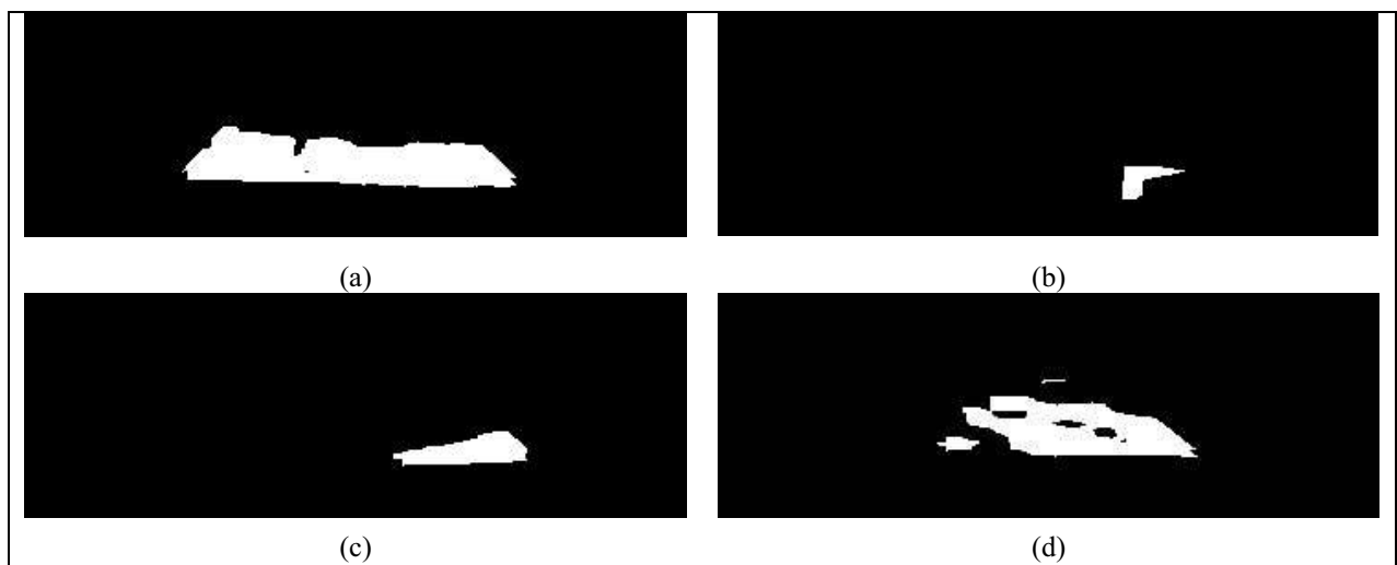
Figura 5.7 – Resultados da Etapa de Inserção de Máscara para Detecção de Caminhos, sendo que em (a) é ilustrado a visão frontal do veículo, em (b) a visão lateral direita do veículo, em (c) a visão da traseira do veículo e em (d) a lateral esquerda do veículo.
