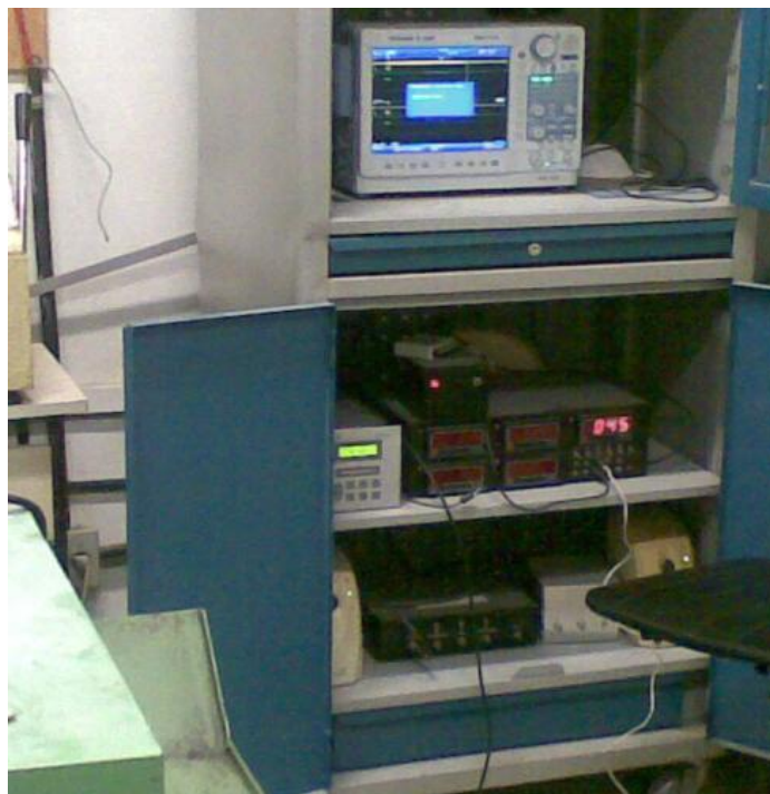
Figura 27. Imagem dos equipamentos da coleta de dados de aceleração, temperatura e emissão acústica.
