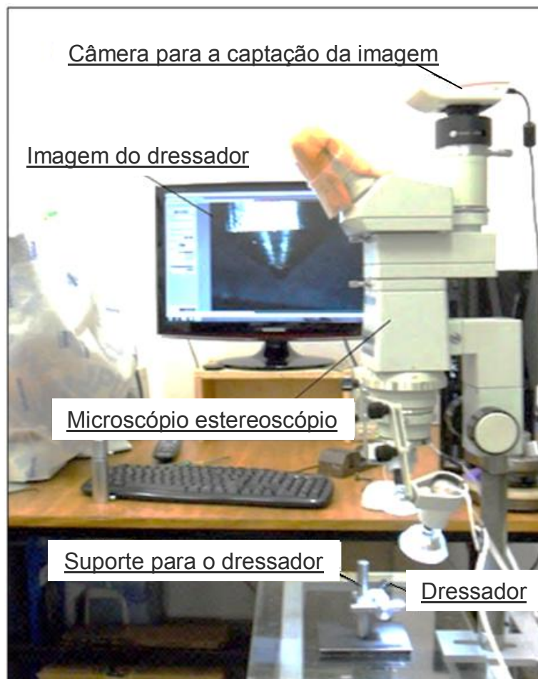
Figura 22. Equipamentos utilizados para captação da imagem da área desgastada do diamante.
