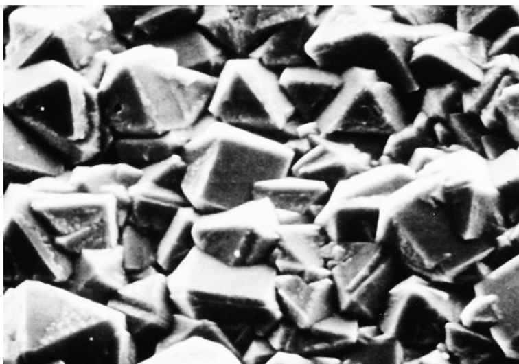
Figura 10. Micrografia eletrônica por varredura de um filme fino de diamante onde são mostrados numerosos micro cristais multifacetados (CALLISTER, 2013 - adaptado).
