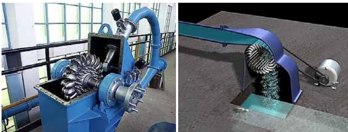
Figura 38 – Ilustrações de turbinas Pelton e Michell Banki respectivamente.
