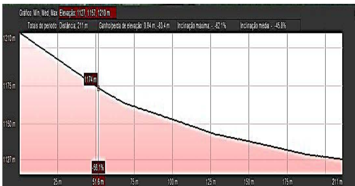
Figura 30 – Perfil de elevação do local de instalação da tubulação
